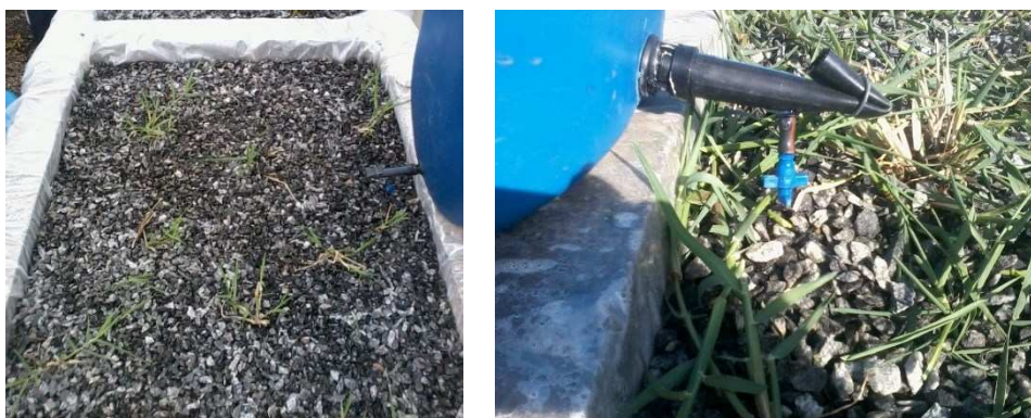
Figura 4. Gotejador GA-2 da AGROJET utilizado para aplicação da solução nutritiva.
