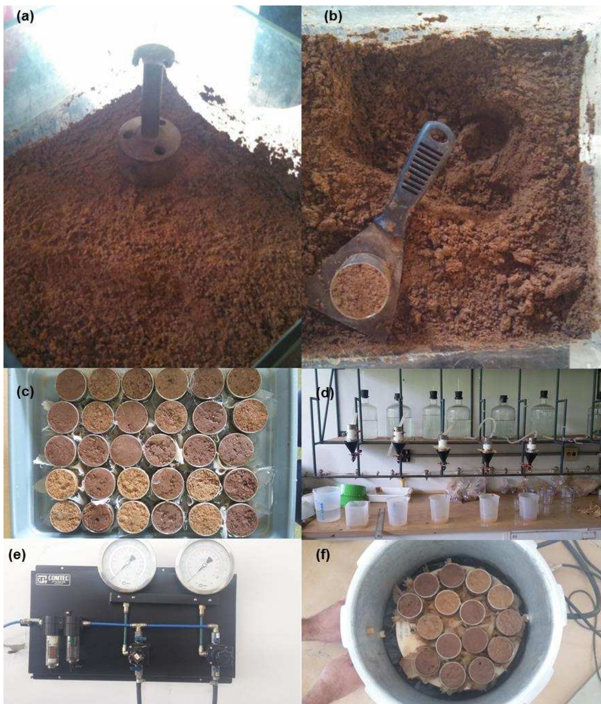
Figura 6. a) Coleta de amostra indeformada em profundidade de 10 cm; b) Exemplo de amostragem pronta para encaminhamento ao laboratório; c) Amostras sendo equilibradas para a primeira análise; d) Avaliação da CH das amostras; e) Medidor de pressão câmara de Richards; f) Mesa de tensão com as amostras. Fonte: A autora.
