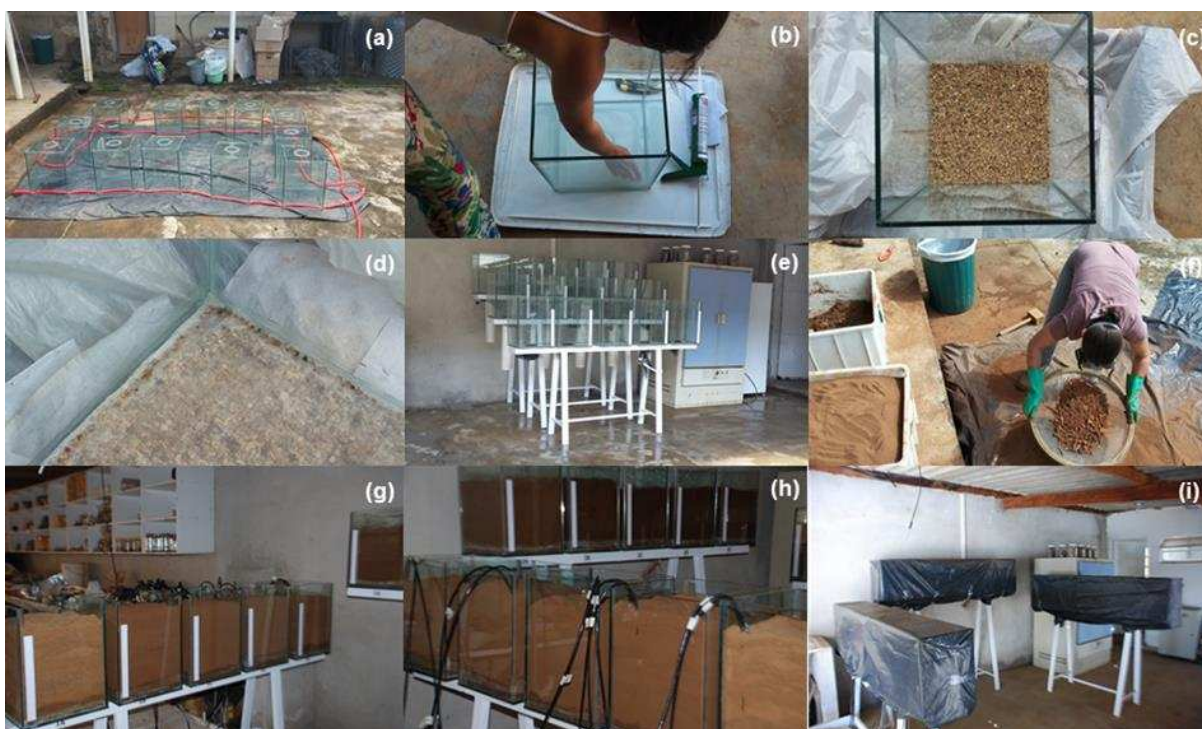
Figura 4. Sequência de montagem das unidades experimentais: a) Aquários montados e lavados com orifício de circular para drenagem da água; b) Primeira camada de sombrite; c) Camada de brita; d) Segunda camada de sombrite; e) Aquários dispostos para montagem; f) Peneiramento do material do rejeito; g) Primeira linha experimental montada; h) Sensores de acompanhamento instalados; i) Linhas experimentais prontas (período de estabilização) cobertas de lona preta. Fonte: A autora.
