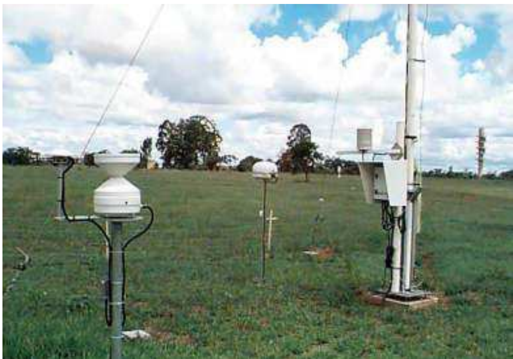
Figura 2.2 - Detalhe de uma estação meteorológica automática, mostrando a esquerda o pluviômetro, ao centro a antena de comunicação via satélite e à direita o "datalogger" com sensor de temperatura fixados ao mastro. Fonte: INMET, 2011.
