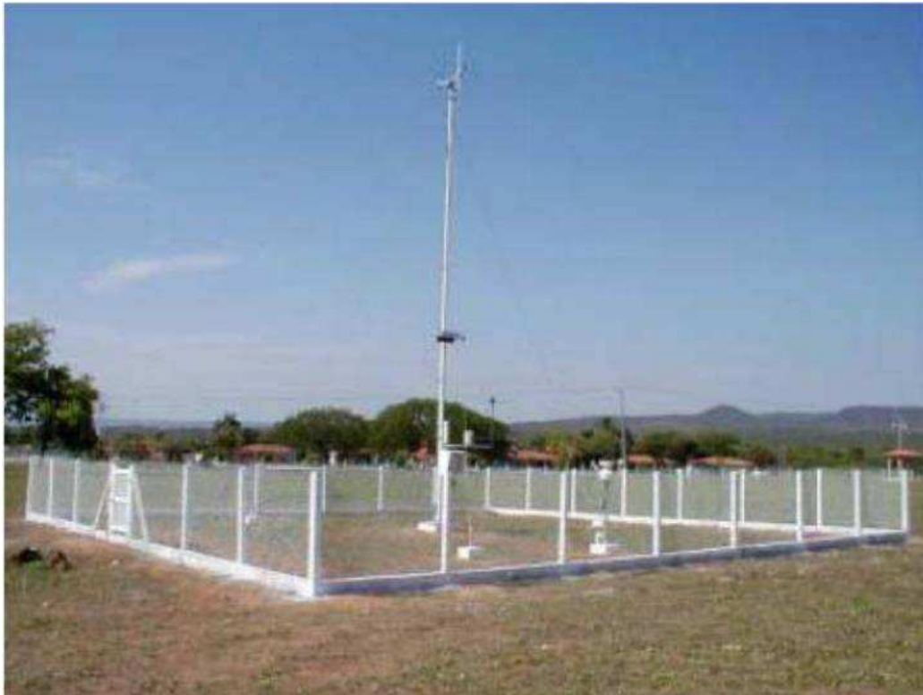
Figura 2.1 - Uma típica estação meteorológica automática – EMA com sensores, mastro com caixa datalogger, painel solar, para-raios, cercada. Fonte: INMET, 2011.
