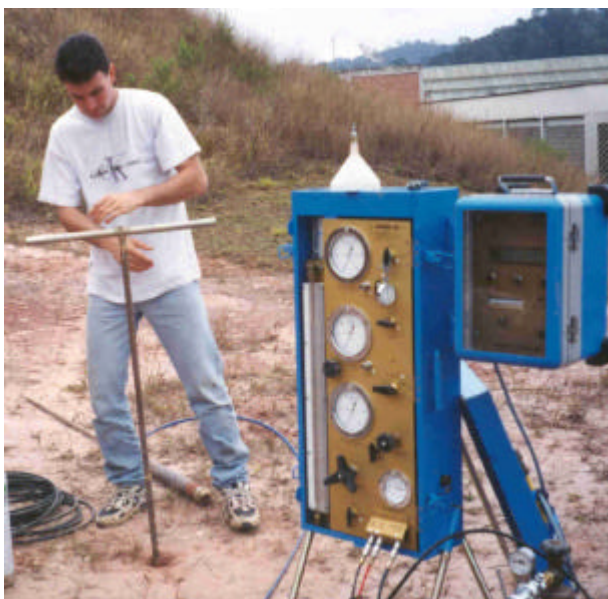
Figura 3.16 – Fase de escavação do pré-furo.
