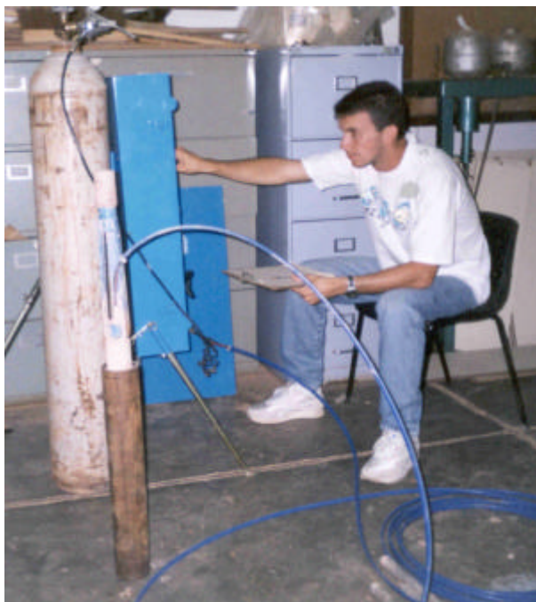
Figura 3.15 – Ensaio de calibração quanto a perdas de volume.
