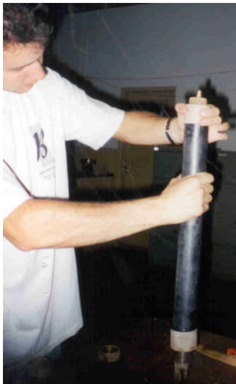
Figura B.2 – Fases de montagem da sonda pressiométrica tipo GC.
