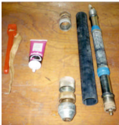
Figura B.1 – Sonda pressiométrica, recobrimento de borracha, braçadeiras, cone de proteção e acessórios para montagem.
