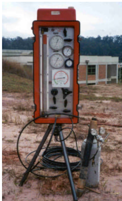
Figura 2.1 – Pressiômetro de Ménard G-200 fabricado pela GEOMATEC
