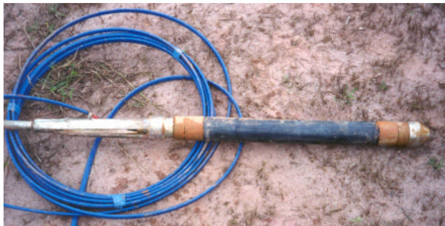
Figura 3.11 – Sonda pressiométrica e mangueiras de conexão.
