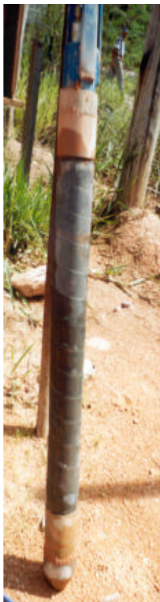
Figura B.3 – Sonda pressiométrica equipada com recobrimento (bainha) reforçada com lona do tipo Canvas.
