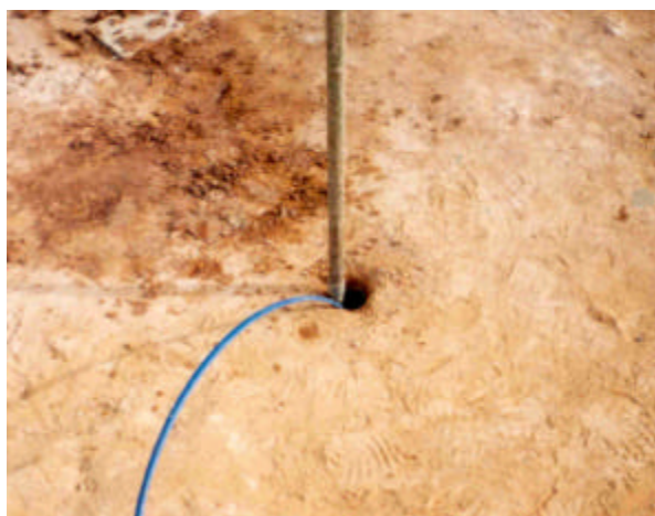
Figura 3.17 – Sonda pressiométrica inserida dentro do pré-furo.
