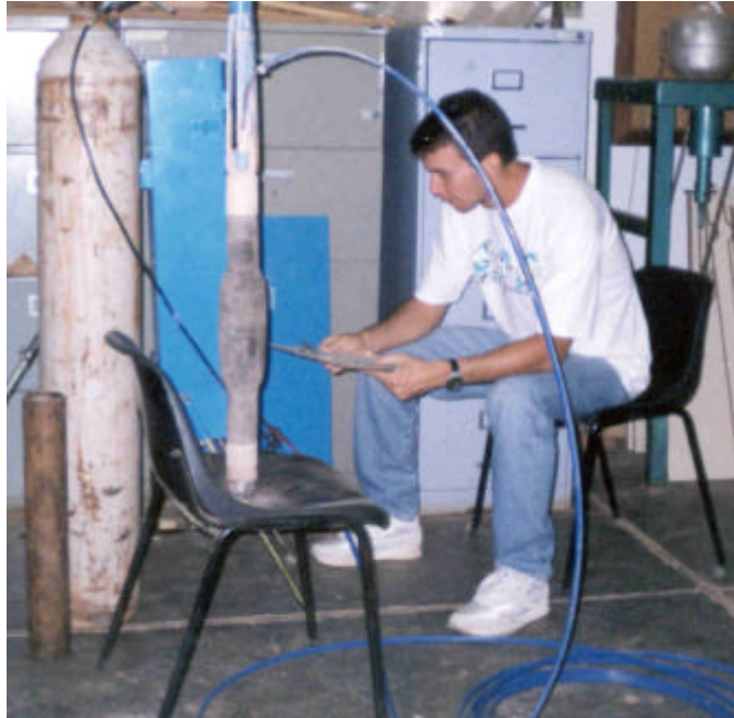
Figura 3.14 – Ensaio de calibração quanto a perdas de pressão.
