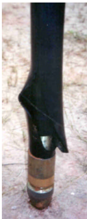
Figura B.4 – Sonda pressiométrica danificada devido a realização de ensaio entre camadas com diferentes resistências.
