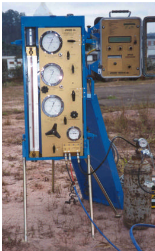
Figura 3.8 – Pressiômetro de Ménard equipado com sistema de aquisição automática de dados, fabricado pela APAGEO SEGELM.
