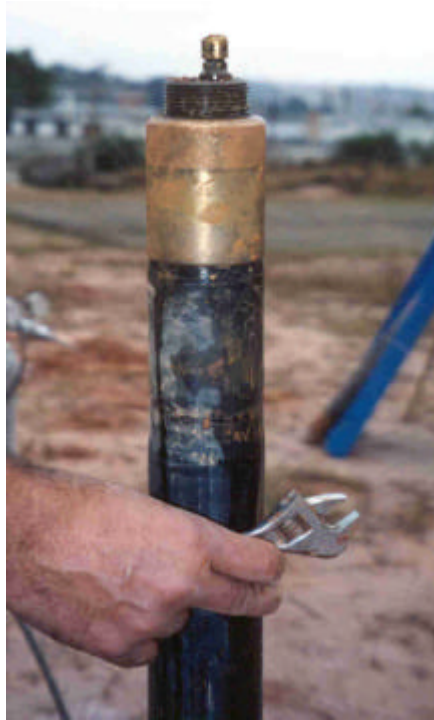
Figura 3.13 – Operação de saturação do sistema – drenagem da sonda (cabeça para baixo).
