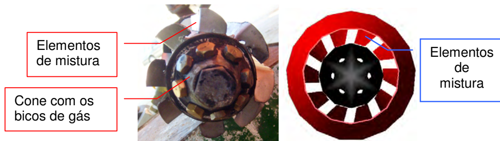
Figura 14 – Vista frontal ilustrando o cone, os bicos de gás e os elementos de mistura.
