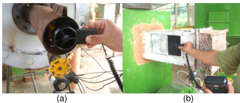
Figura 20 – Anemômetro digital de pás rotativas medindo as velocidades do ar primário (a) e do ar secundário (b).
