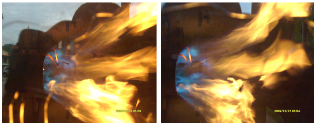
Figura 31 – Chamas formadas no gerador de gás quente com o bico de 45 graus.
