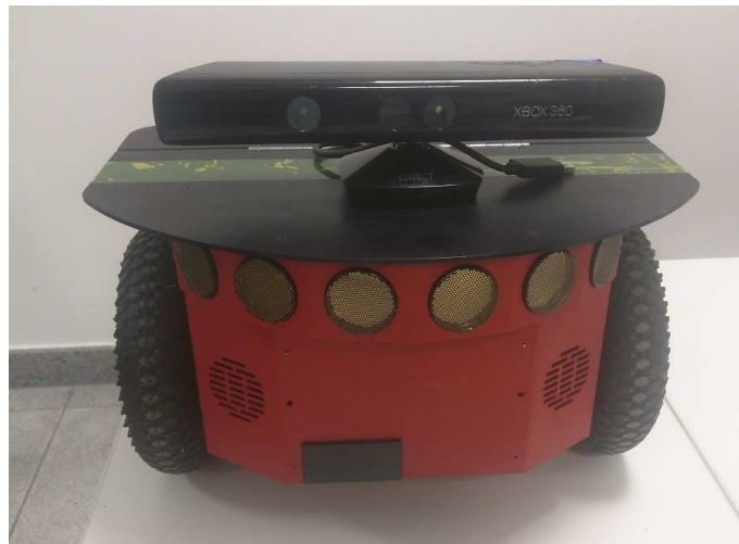
Figura 1.14. Kinect para Xbox 360 acoplado ao P3-DX.
