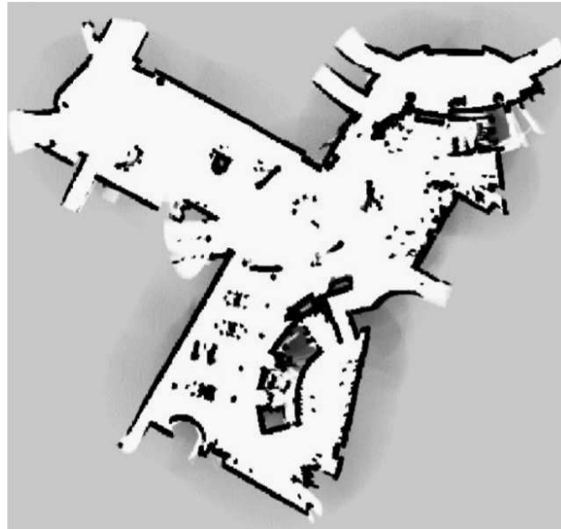
Figura 1.10. Mapa da Figura 1.9 obtido através de Occupancy Grid.
