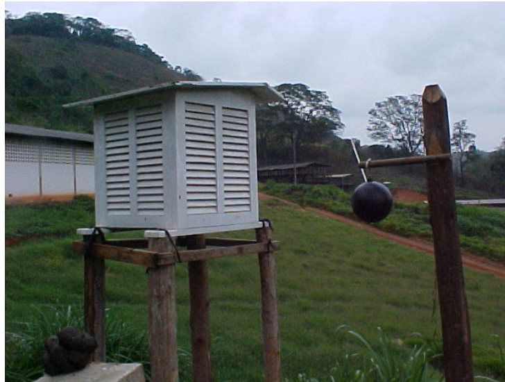
FIGURA 7 – Abrigo meteorológico com os instrumentos de medição das variáveis climáticas no ambiente externo
