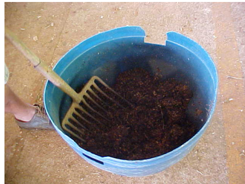
FIGURA 9 – Detalhe da técnica utilizada para homogeneização das amostras
