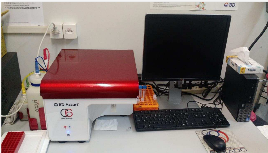
Figura 3 – Aparelho BDAccuri C6 (Beckton-Dickeson, San Jose, USA) utilizado para análise das amostras por citometria de fluxo. Local: LMMD-FZEA/USP.
