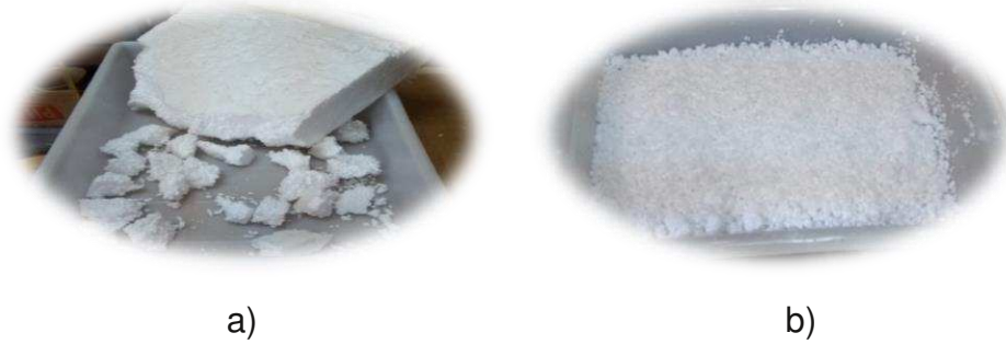
Figura 2.2-Detalhes do resíduo de EPS coletado (a) e após o processo de trituração (b).
