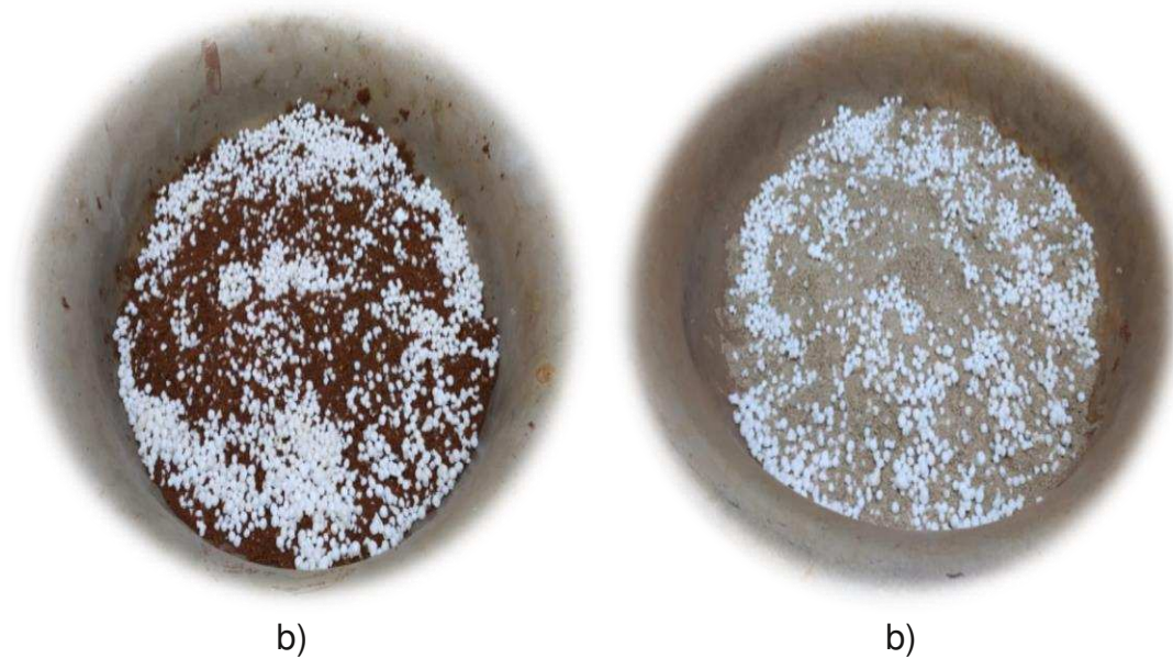
Figura 3.3-Detalhes das misturas do resíduo de EPS triturado com amostras de solo BR-120 (a) e de solo Vila Secundino (b).
