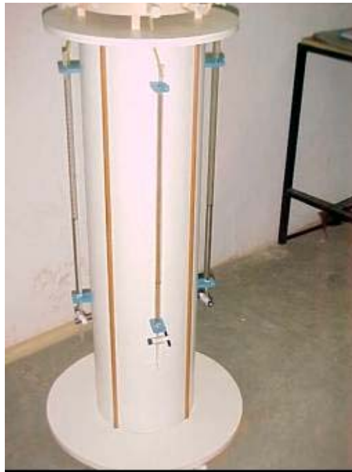
Figura 3.10 – Suporte para o equipamento com as buretas acopladas
