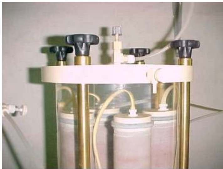
Figura 3.5 (a), (b), (c) – Permeômetro construído no Laboratório de Geotecnia-DEC/UFV
