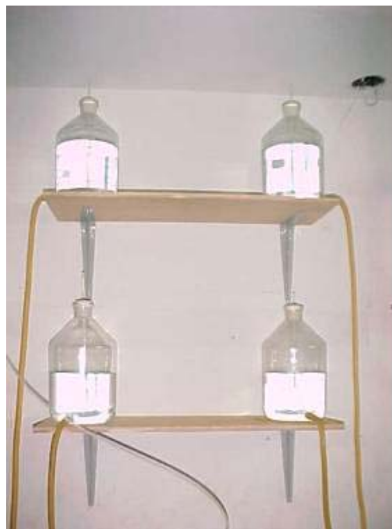
Figura 3.9 – Disposição dos frascos de Mariotte
