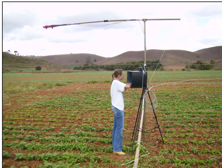
Figura 2. Sistema de aquisição das imagens nas parcelas experimentais.
