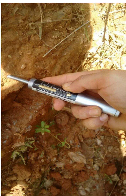
Figura 2. Penetrômetro de campo usado para medir a resistência do solo à penetração. Foto: Ricardo Meireles.
