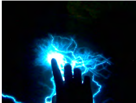
Figura 3.7: Exemplo de ruptura dielétrica em um disco de plasma.
