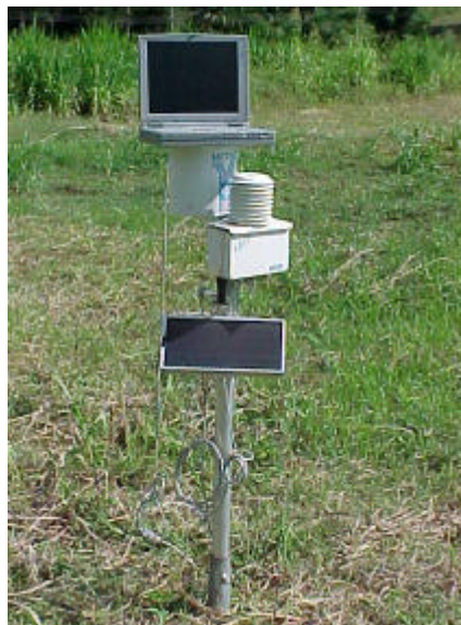
Figura 1C – Estação meteorológica automática e anemômetro totalizador utilizados para obtenção de dados climáticos.
