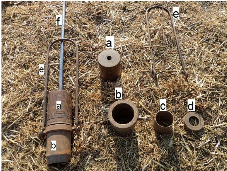
(a) peso responsável pelo impacto e percussão; (b) copo amostrado; (c) cilindro metálico; (d) arruela de ajuste do cilindro metálico ao copo amostrador; (e) haste extratora do copo amostrador; (f) haste de deslocamento do peso de impacto.
