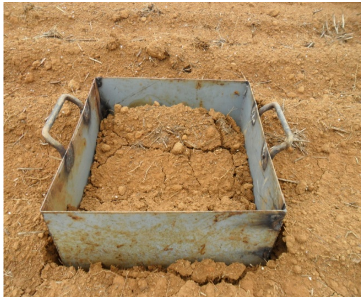
Figura 8 - Armação metálica usada para coleta de amostra para determinação de diâmetro médio ponderado dos agregados do solo.
