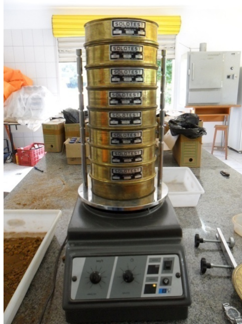
Figura 9 - Agitador eletromagnético equipado com peneiras de malhas 19,1; 9,52; 4,76; 2,38; 1,19; 0,59; 0,29; 0,14 e < 0,14 mm, usado para determinação dos valores de diâmetro médio ponderado dos agregados do solo.
