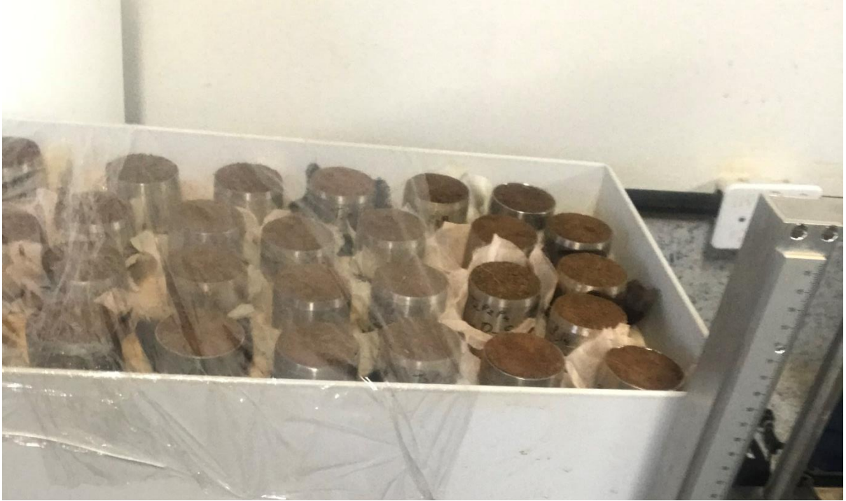
Figura 17 - Amostras indeformadas colocadas na mesa de tensão. Rio Paranaíba-MG.
