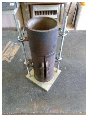
Figura 6 —Molde cilíndrico bipartido utilizado no ensaio de resistência à compressão não confinada.
