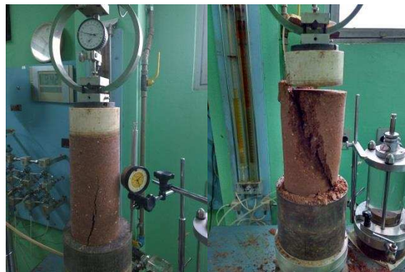
Figura 9 –Detalhe do ensaio de resistência à compressão não confinada.
