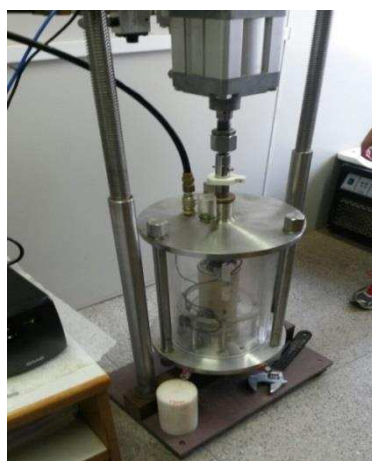
Figura 17 —Célula triaxial empregada no ensaio de módulo de resiliência.
