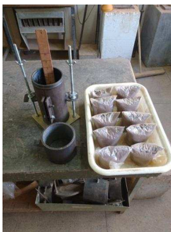
Figura 16 —Moldagem dos corpos de prova para o ensaio de módulo de resiliência.
