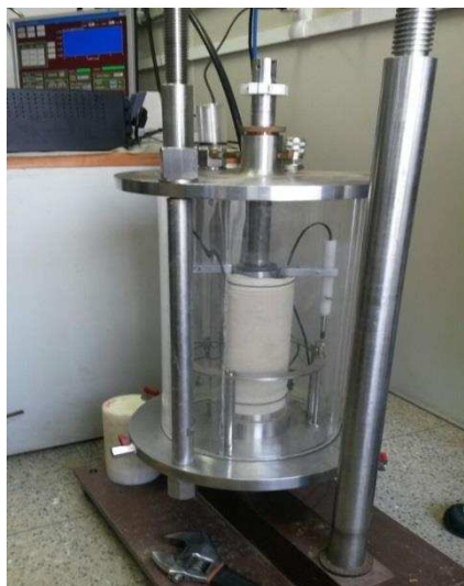
Figura 21 –Equipamento triaxial de cargas repetidas do laboratório de pavimentação da UFJF.
