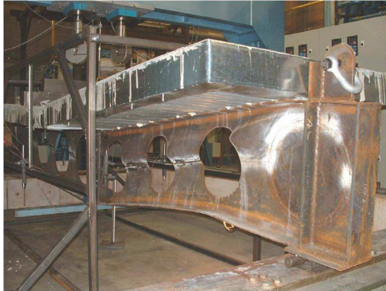
Figura 3.16– Modo de colapso observado no modelo experimental Beam B1 (NADJAI, 2005 apud BAKE, 2010).
