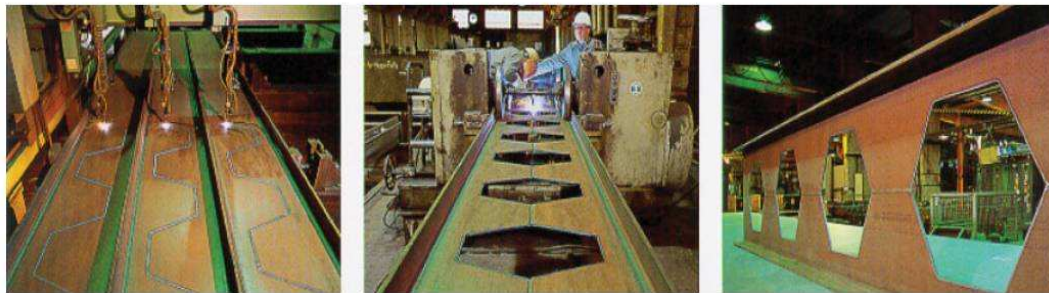
Figura 1.1 – Fabricação de uma viga alveolar: corte com máquinas CNC 1 e processo de soldagem (GEMPERLE, 2007).
