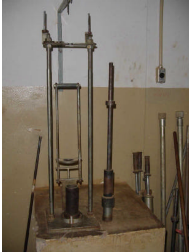
Figura 25 – Equipamento utilizado para moldagem dos corpos-de-prova na energia do ensaio Proctor Intermediário (compactação por impacto)
