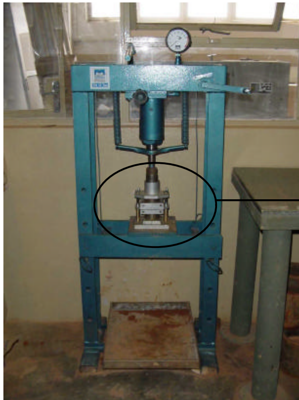
Figura 26 – Equipamento utilizado para moldagem dos corpos-de-prova na energia do ensaio Proctor Modificado (compactação estática)
