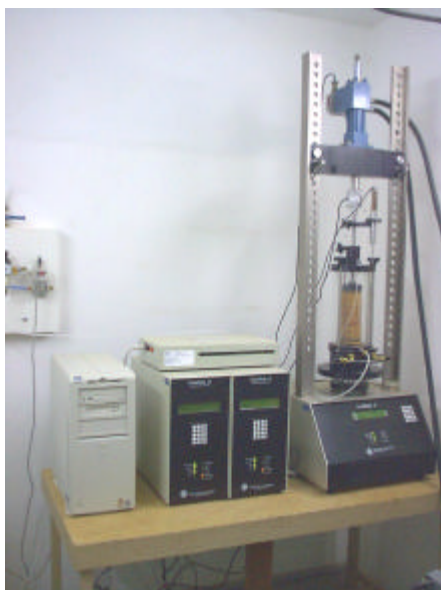
Figura 27 - Conjunto para realização do ensaio triaxial dinâmico
