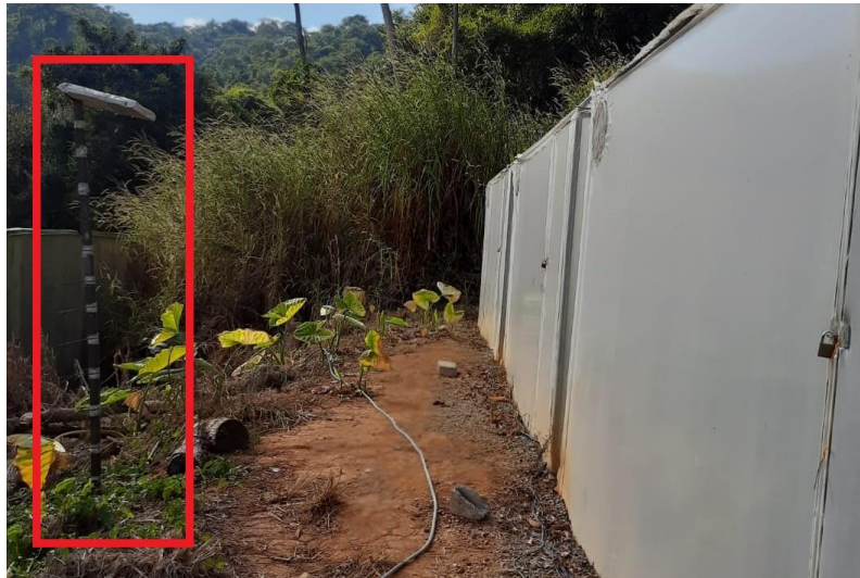
Figura 4 - Localização do sensor DHT22 responsável pelas leituras de temperatura do ar e umidade relativa externa as estufas
