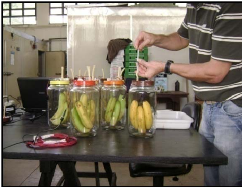
Figura 6 – Acondicionamento de bananas para acúmulo de CO 2 e retirada de amostras da atmosfera interna dos frascos.
