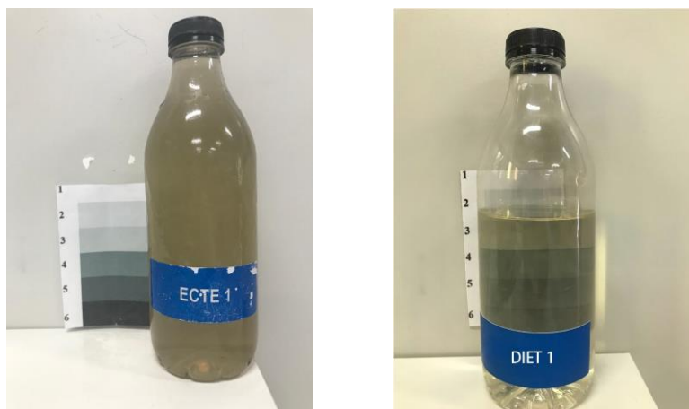
Figura 5.1 - Exemplos da classificação das amostras por meio da escala cinza realizada pelos estudantes.
