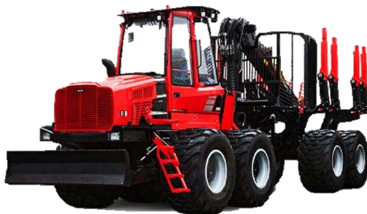
Figura 2. Trator florestal Forwarder fabricado pela Komatsu, modelo 895. Fonte: Komatsu.
