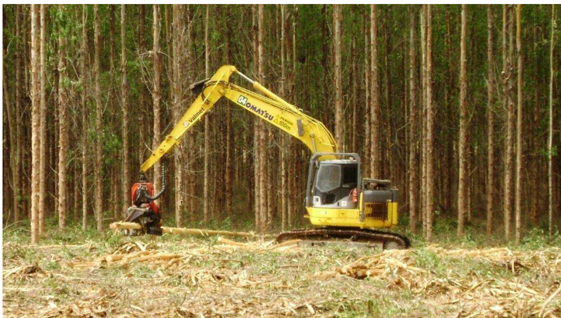
Figura 3. Trator florestal harvester fabricado pela Komatsu, modelo PC-228. Fonte: CENIBRA
