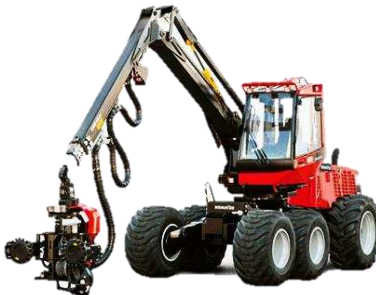
Figura 1. Trator florestal harvester fabricado pelo Komatsu, modelo 895. Fonte: Komatsu.
