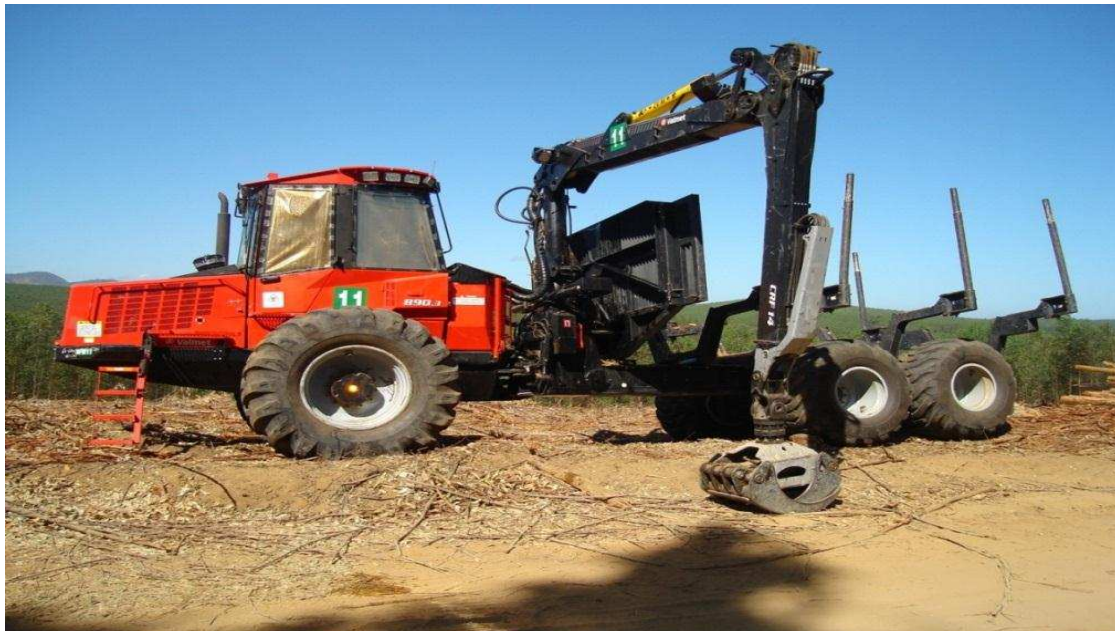
Figura 4. Trator florestal forwarder fabricado pela Komatsu, modelo 890.3. Fonte: CENIBRA
