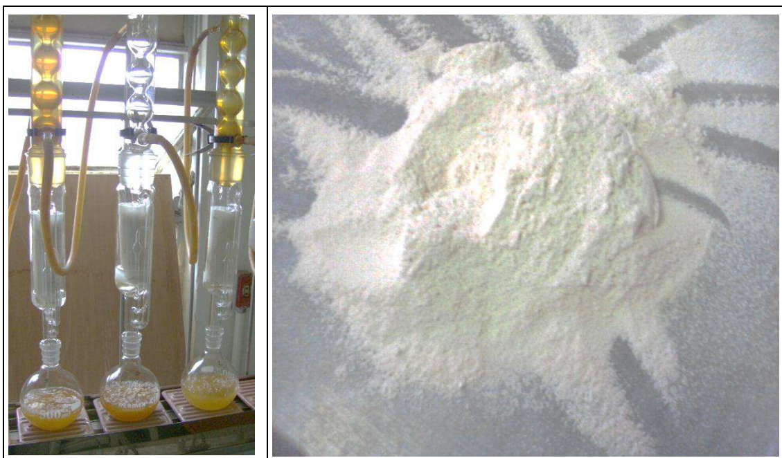
Figura 7 – Extração de óleo em aparelho Soxhlet e farelo de Amêndoa de Pinhão-Manso desengordurado e peneirado, granulometria 0,35 mm
