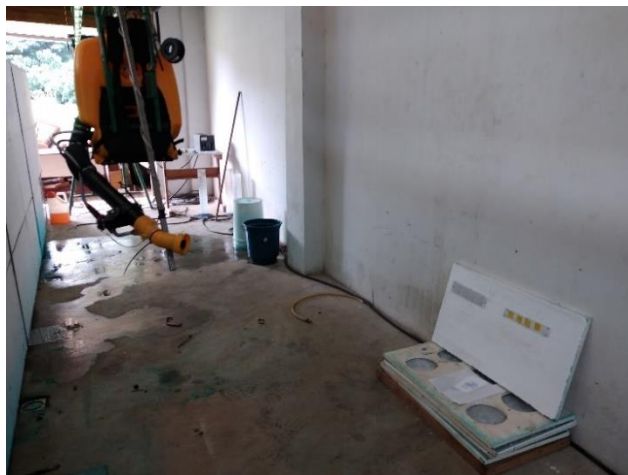
Figura 6 - Destaque do posicionamento do pulverizador pneumático e da estrutura de fixação dos folíolos.
