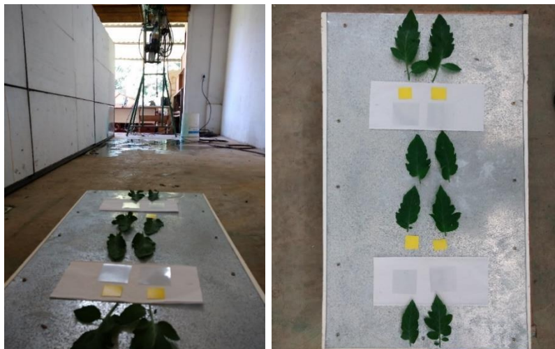
Figura 4 - Posicionamento dos folíolos e etiquetas hidrossensíveis sob a ponte rolante para os tratamentos utilizando o pulverizador hidráulico.
