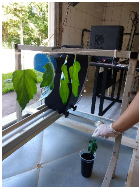
Figura 1 – Representações do tratamento dos folíolos utilizando o método da imersão e da secagem após o tratamento
