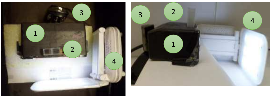
Figura 10. Sistema ilustrativo para obtenção de imagens digitais em que 1. Suporte para cubetas; 2. Cubetas para colocar amostra; 3. Webcam; 4. Fonte de luz.
