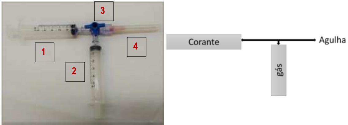
Figura 32. Sistema de reação de fosfina com azul de metileno para sua quantificação pelo método espectrofotométrico. 1 é a seringa com solução; 2 a seringa com gás; 3 é a válvula controle e 4 é a agulha para a extração.
