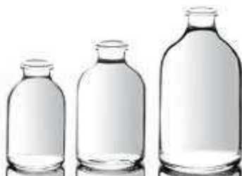
Figura 9. Frascos de vidro com capacidade volumétrica de 20, 30 e 50 mL utilizados no desenvolvimento do método iodométrico.
