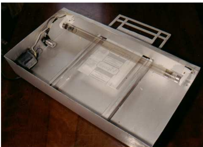
Figura 8 – Modelo aberto para exposição das embalagens à radiação UV, onde se visualiza a canaleta por onde corre o suporte com a embalagem.
