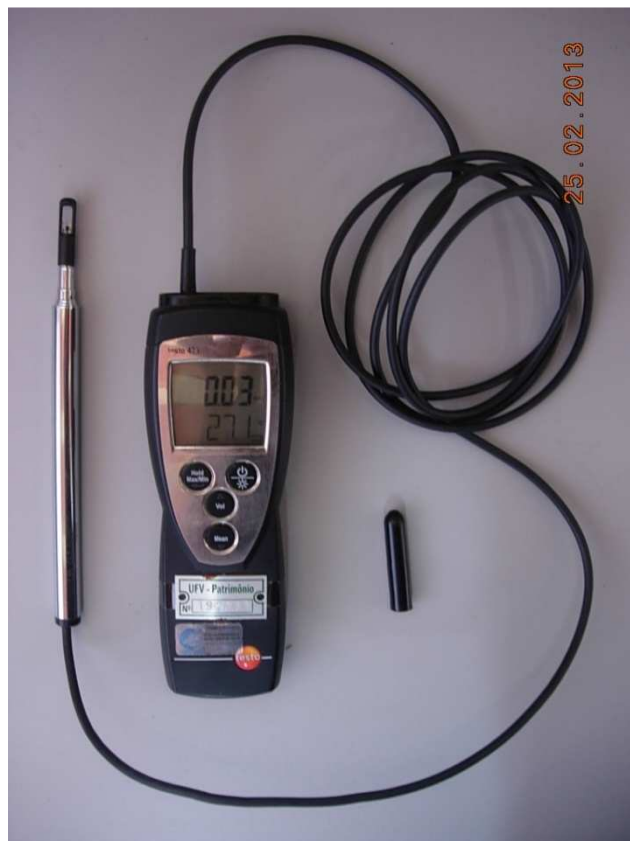
Figura 24 - Termo-anemômetro de fio quente utilizado na medição de velocidade do ar de entrada e saída dos protótipos.
