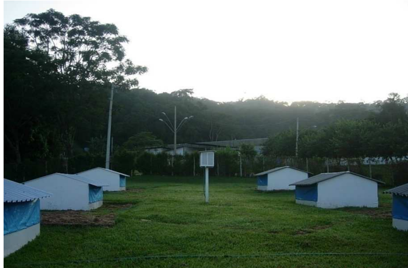
Figura 7 - Vista da área experimental mostrando os seis protótipos de galpões avícolas e abrigo meteorológico ao centro.
