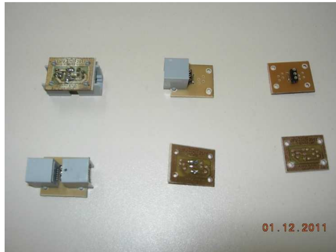
Figura 20 - Fases do desenvolvimento do circuito para receber os sensores - dispositivos digitais endereçáveis (tecnologia 1-wire).
