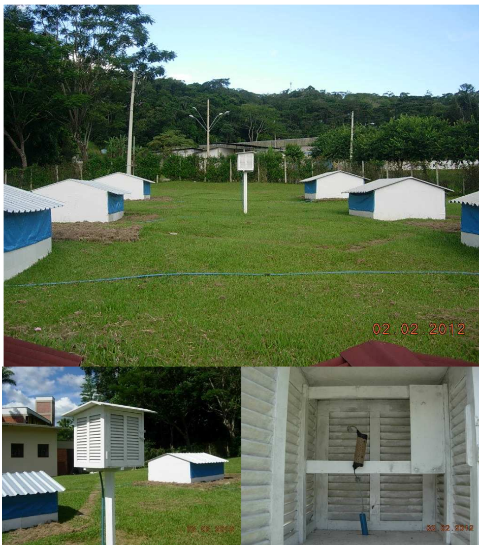
Figura 19 - Vista do interior do abrigo meteorológico, bem como sua posição relativa à distribuição espacial dos protótipos na área experimental.
