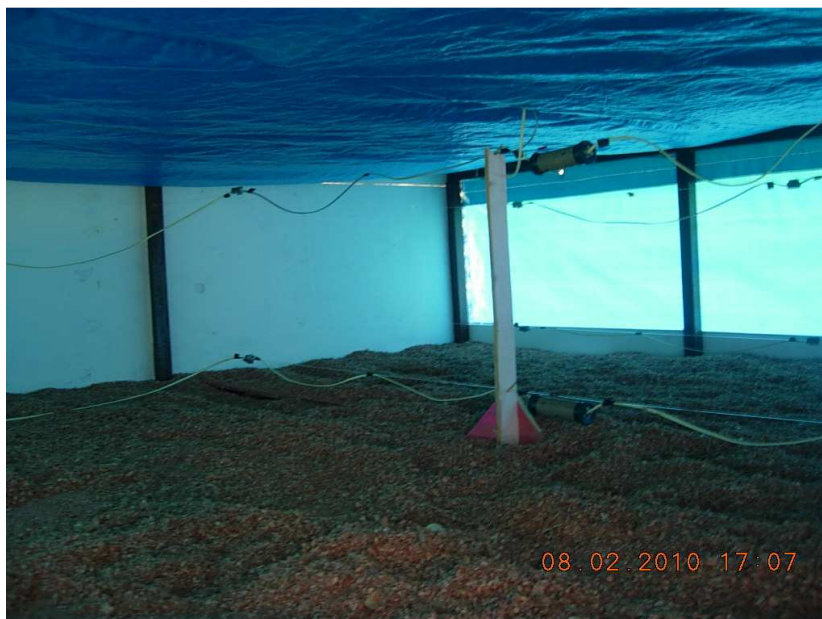
Figura 17 - Protótipo com presença de forro de polietileno posicionado horizontalmente sob o telhado.
