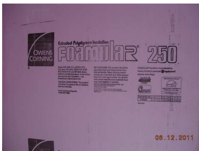
Figura 15 - Material isolante (Polietileno Extrudado) empregado em dois protótipos.
