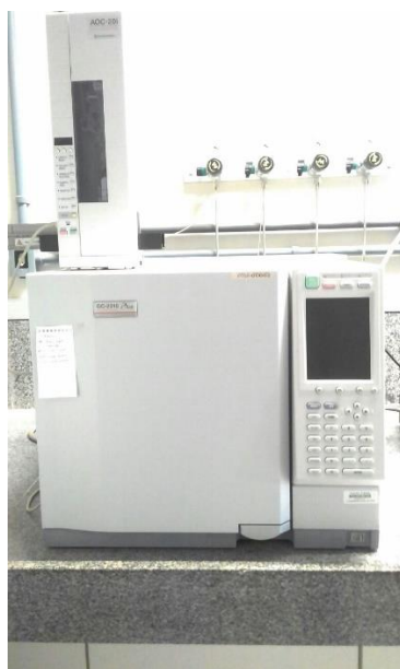
Figura 30: Cromatógrafo a gás equipado com detector de ionização por chama e injetor automático.
