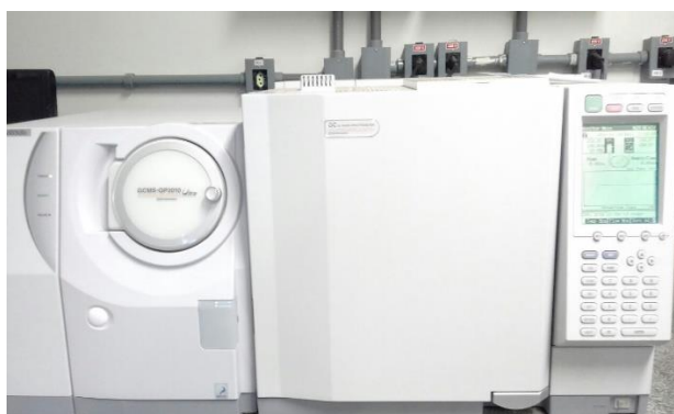
Figura 31: Cromatógrafo a gás acoplado à um espectrômetro de massas utilizado nas identificações dos produtos.
