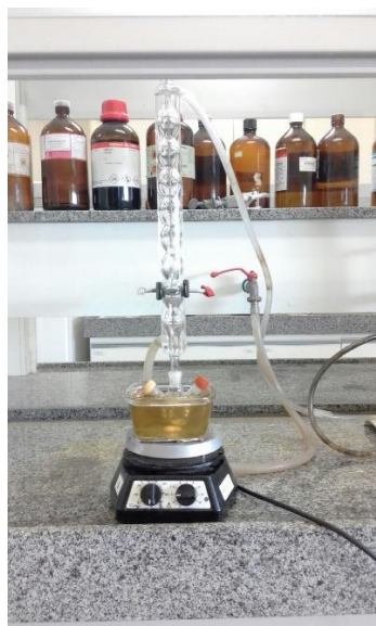
Figura 29: Reator utilizado para as reações de acetalização do furfural e oxidação de álcoois terpênicos.
