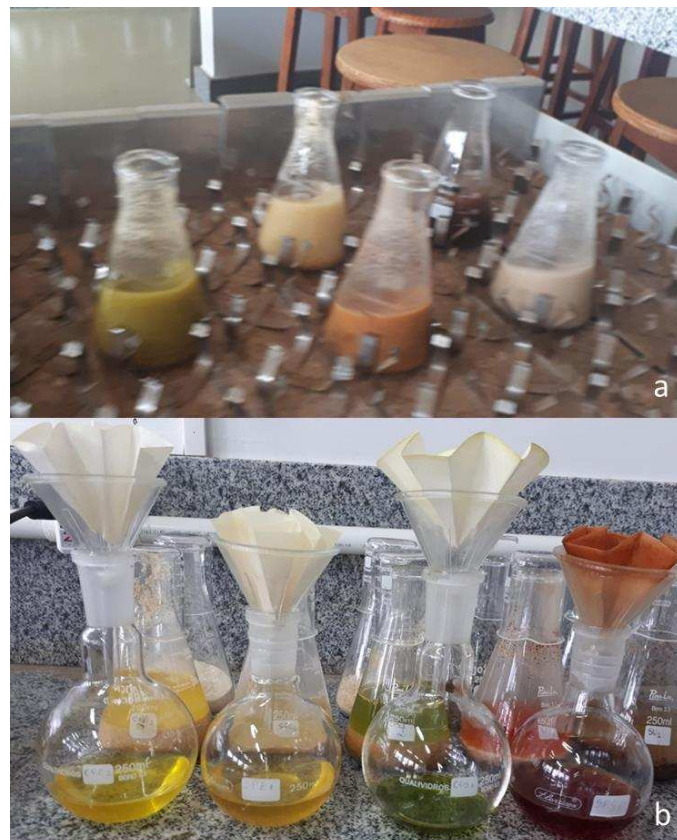
Figura 2 - Obtenção dos extratos de Passiflora por maceração com agitação em mesa agitadora tipo shaker (a) e filtração (b)
