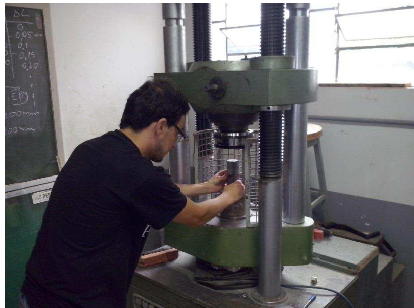
Figura 31: Disposição do corpo-de-prova na máquina de ensaio uniaxial.
