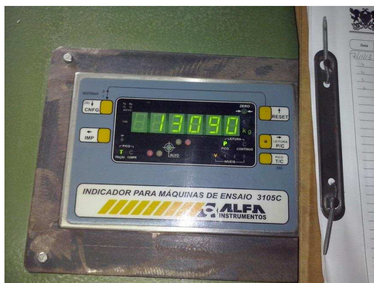
Figura 33: Equipamento indicador da força aplicada sobre a amostra na máquina universal.
