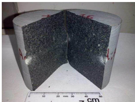
Figura 26 - Validação dos ensaios diametraes: (a) Válido; (b) Inválido.
