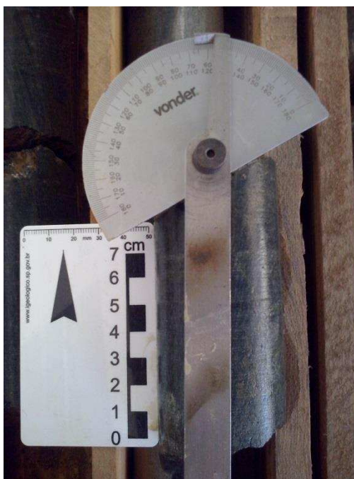
Figura 17: Utilização do goniômetro para medição dos ângulos das descontinuidades em relação ao eixo do testemunho.
