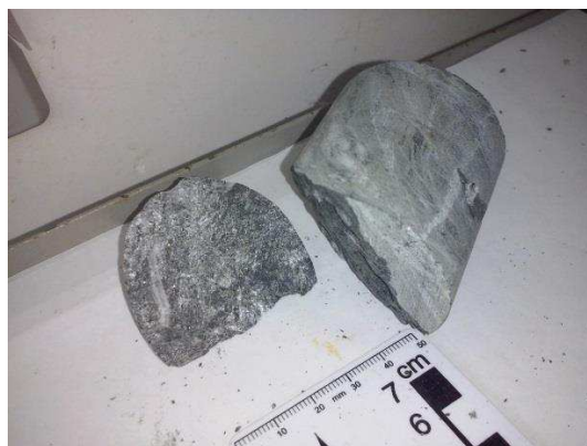
Figura 26 - Validação dos ensaios diametraes: (a) Válido; (b) Inválido.
