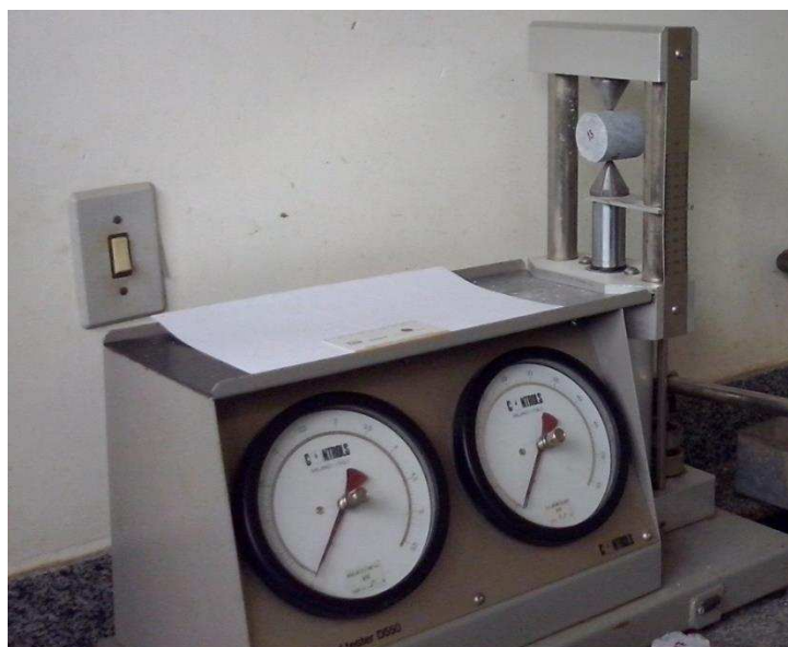
Figura 25: Arranjo do ensaio de carga pontual diametral.
