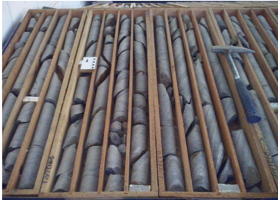
Figura 18: Múltipla fraturas em Anfibolito foliado com, pelo menos, três famílias de fraturas detectadas nas 3 caixas de testemunhos de sondagem fotografadas.
