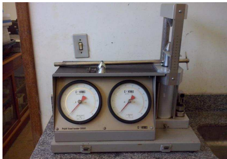
Figura 23: Máquina e aparelhagem para ensaio de resistência à compressão puntiforme.
