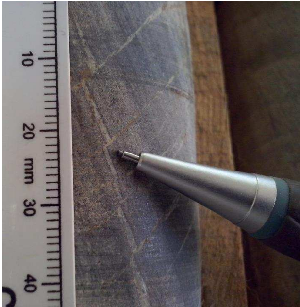
Figura 44: Microfalhas evidenciadas em lentes no anfibolito.
