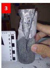
Figura 3: Certificado dos resultados do ensaio para determinação da resistência à compressão uniaxial do anfibolito quartzoso, maciço e sem alteração (A1).
