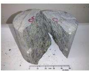
Figura 16: Certificado dos resultados do ensaio para determinação do índice de resistência à compressão puntiforme, carregamento diametral, do xisto grafitoso com foliação marcante e grau de alteração A2.
