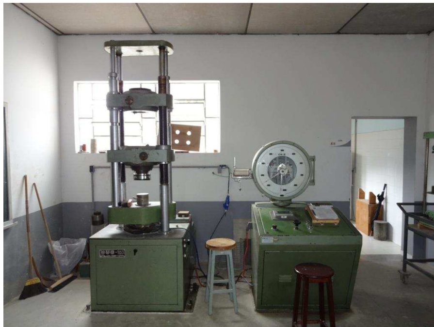
Figura 29: Máquina universal de compressão utilizada nos ensaios de compressão uniaxial.
