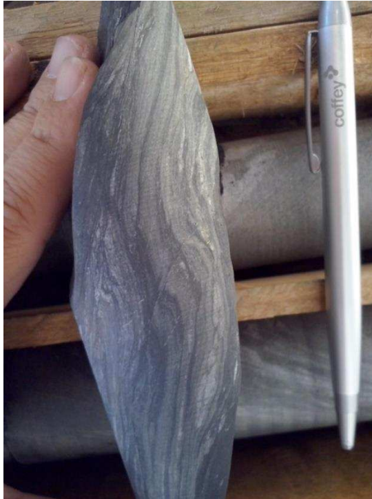
Figura 42: Foliação dobrada e microfalhas em xisto grafitoso proveniente da zona de perturbação da falha de Volta Grande.
