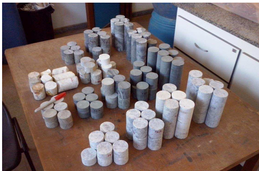
Figura 19: Corpos-de-prova utilizados nos ensaios de resistência à carga pontual, à compressão simples e de caracterização de índices físicos.
