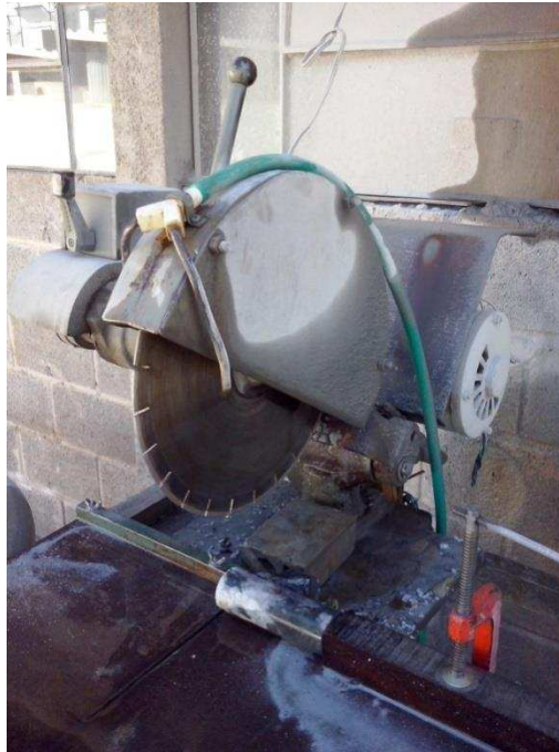
Figura 21: Serra diamantada utilizada para corte das amostras de rocha.
