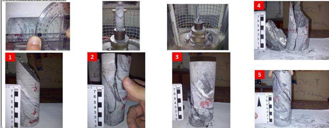
Figura 6: Certificado dos resultados do ensaio para determinação da resistência à compressão uniaxial do xisto grafitoso, grau de alteração A2, com foliação marcante.
