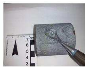
Figura 16: Certificado dos resultados do ensaio para determinação do índice de resistência à compressão puntiforme, carregamento diametral, do xisto grafitoso com foliação marcante e grau de alteração A2.
