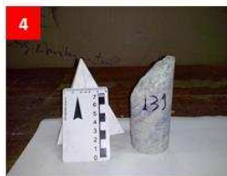
Figura 4: Certificado dos resultados do ensaio para determinação da resistência à compressão uniaxial do pegmatito de granulação grosseira, fraturado e sem alteração (A1).
