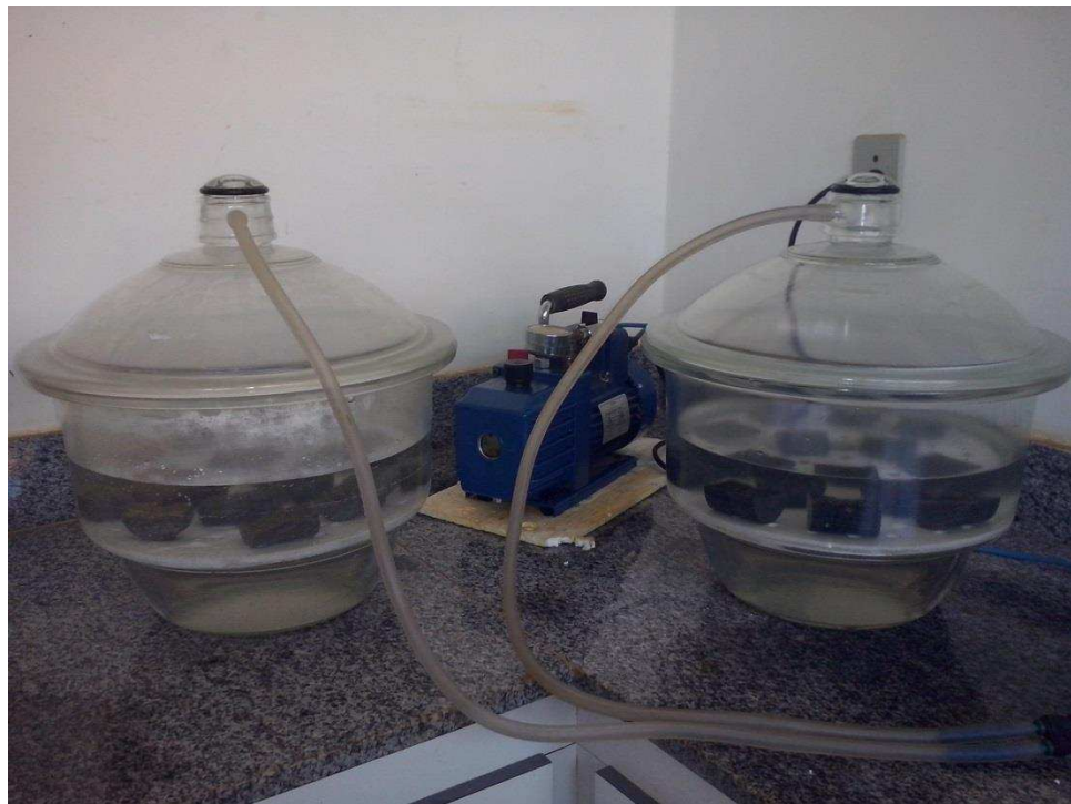
Figura 34: Conjunto dessecador-bomba de vácuo.
