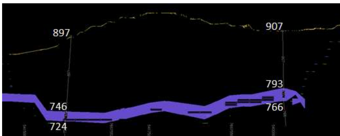
Figura 14: Seção transversal do corpo A mostrando a frente de lavra, para a proposta de cava final, com as profundidades do corpo pegmatítico (cor roxa) em relação à superfície (linha amarela). Fonte: extraído do modelo geológico da mina de Volta Grande (2014).
