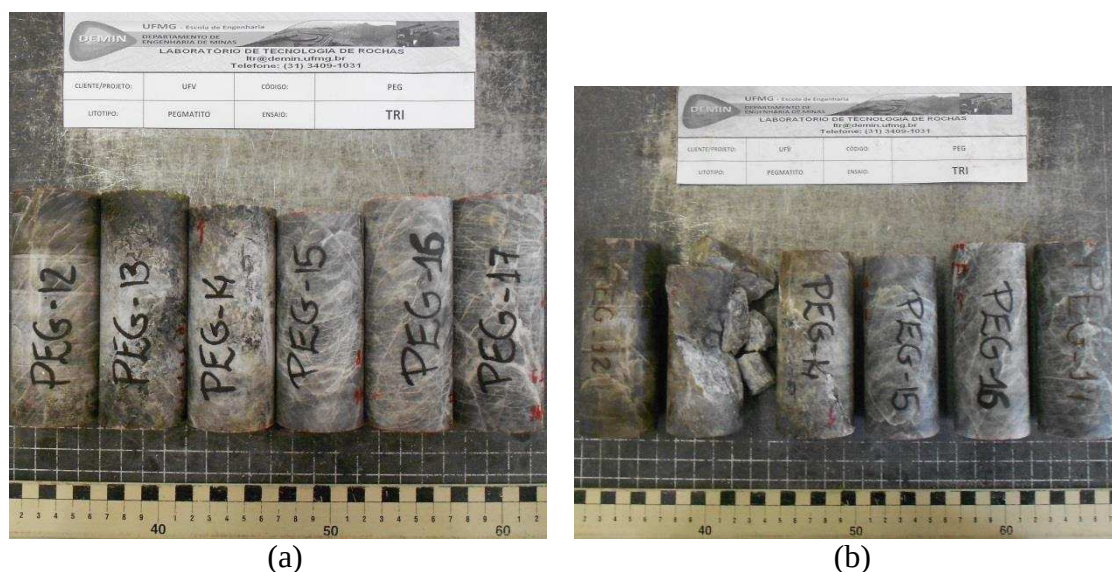
Figura 71: Corpos-de-prova do ensaio triaxial em pegmatito (a) antes do ensaio; (b) rompido.
