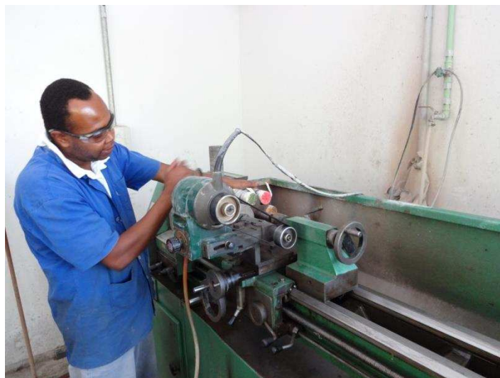
Figura 39: Retífica adaptada para polimento das superfícies das amostras.
