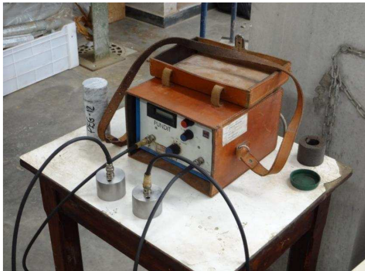
Figura 37: Aparelho PUNDIT para testes de velocidade de propagação de ondas.
