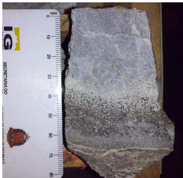
Figura 45: Contato geológico pegmatito-anfibolito, com presença de biotita no contato.
