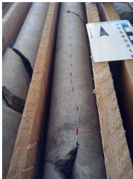
Figura 54: Fratura sub-vertical (tracejado) preenchida, ao longo de testemunho de anfibolito.
