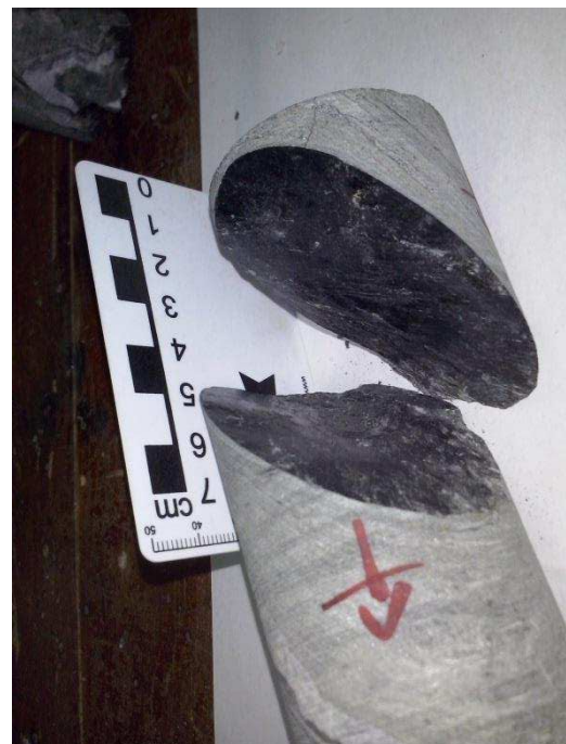
Figura 58: Ruptura de amostra do xisto grafitoso ao longo da foliação.
