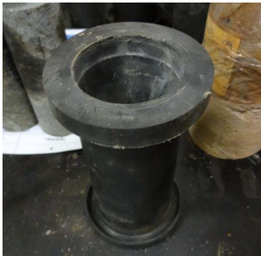
Figura 41: Aparatos para o ensaio triaxial: (a) borracha envoltória do corpo-de-prova; (b) célula para execução do ensaio
