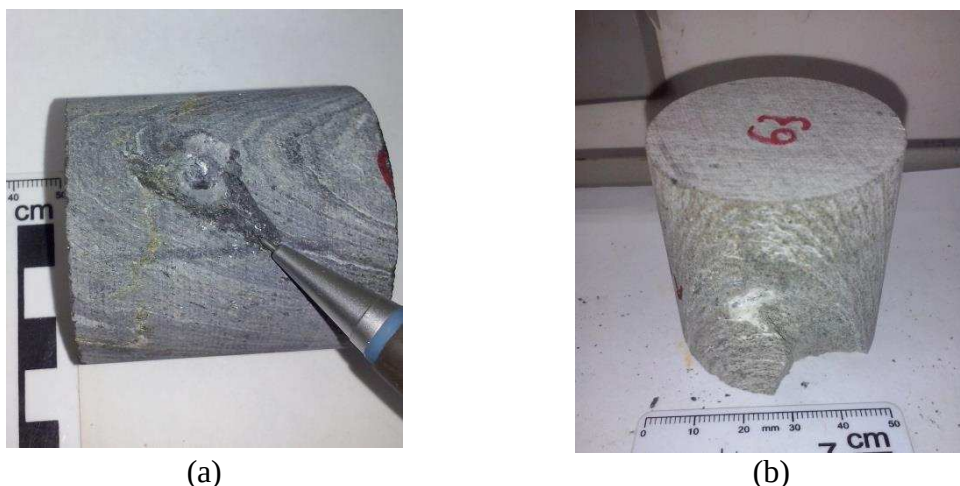
Figura 59: Invalidação de ensaios puntiformes diametraes. Em que: (a) penetração da ponteira cônica na direção perpendicular à foliação em xisto grafitoso A2, ensaiado diametralmente; (b) ruptura precoce, no carregamento diametral normal à foliação em anfibolito A2/3, não passante pelos pontos de aplicação da carga.
