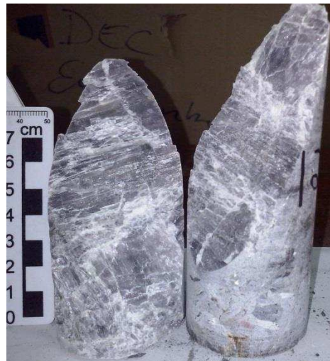
Cisalhamento pegmatito grosso e fraturado
