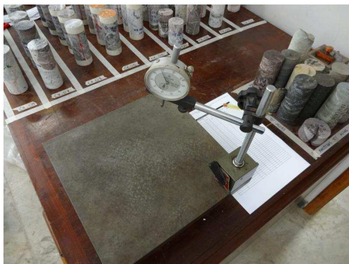
Figura 40: Mesa de verificação de polimento e paralelismo das faces das amostras.
