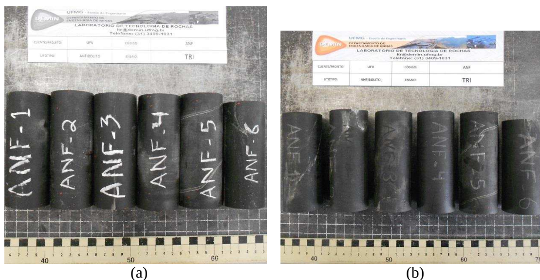
Figura 66: Corpos-de-prova do ensaio triaxial em anfibolito maciço, sem foliação: (a) antes do ensaio; (b) rompido.
