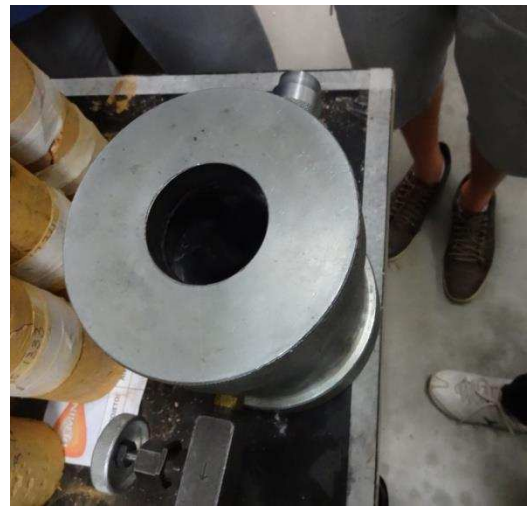
Figura 41: Aparatos para o ensaio triaxial: (a) borracha envoltória do corpo-de-prova; (b) célula para execução do ensaio
