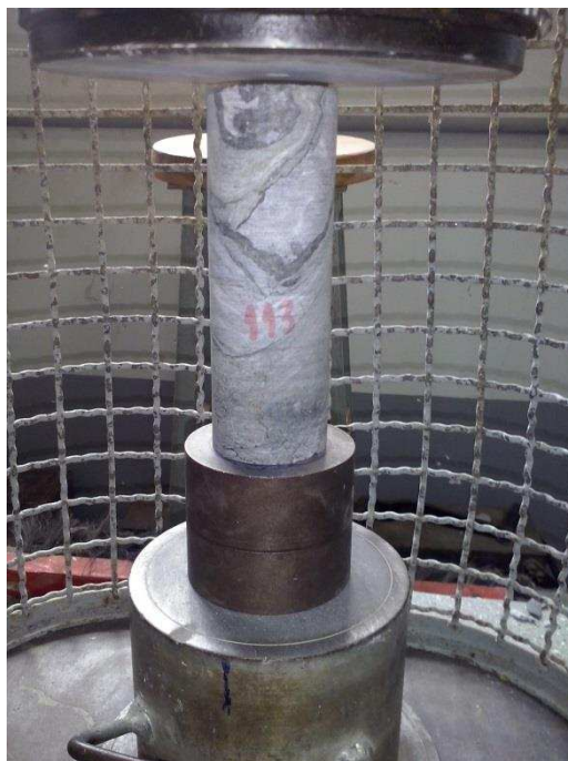
Figura 58: Ruptura de amostra do xisto grafitoso ao longo da foliação.
