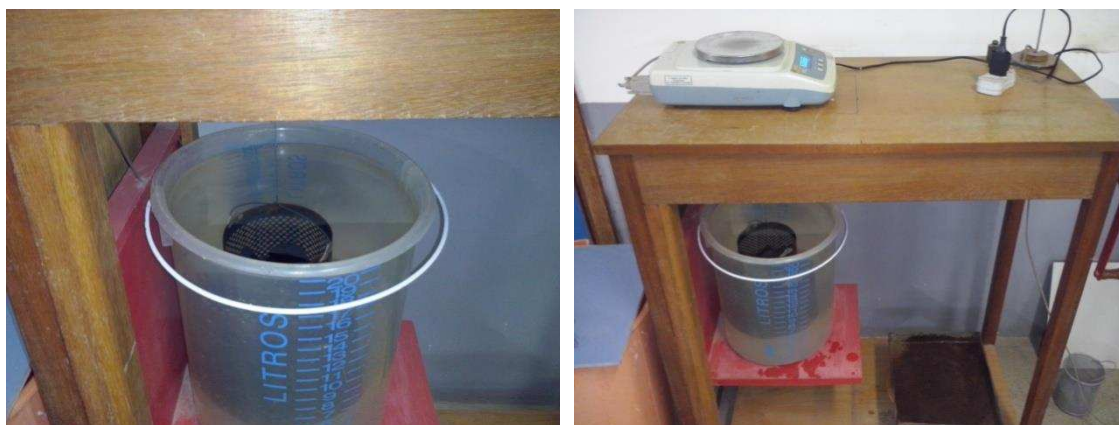
Figura 35: Aparato para imersão das amostras e realização do método da flutuabilidade.
