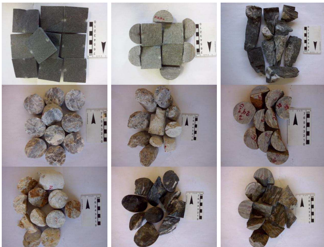
Figura 36: Amostras utilizadas nos ensaios de índices físicos.
