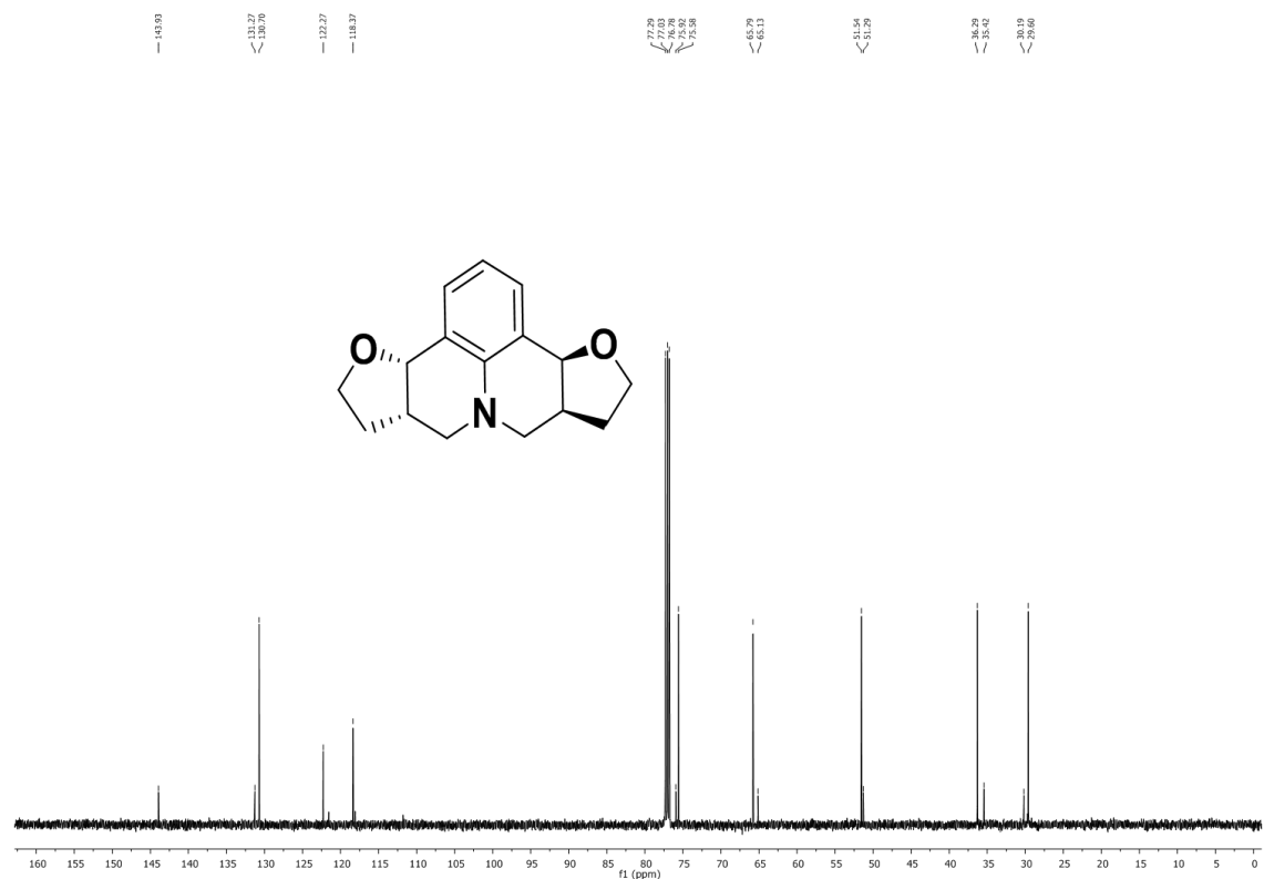
Figura 146. Espectro de RMN de ^{13}\text{C} (75 MHz; \text{CDCl}_3 , \delta_{\text{CHCl}_3} 77,00 ppm) da julolidina 14(±)-T.
