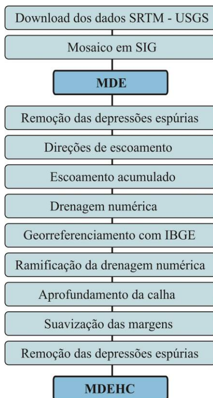
Figura 4 – Fluxograma das etapas envolvidas na geração do Modelo Digital de Elevação Hidrologicamente Consistente (MDEHC)
