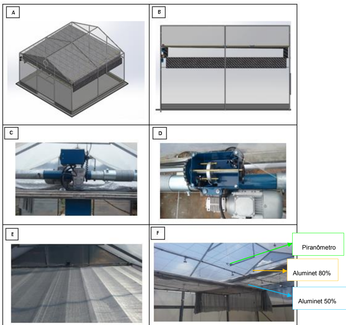
Figura 1.1. Projeto 3D da casa de vegetação automatizada com sistemas de malhas sobrepostas (A e B). Sistema de tracionamento das malhas compostos por motoredutor, eixo e polias (C, D e E) e localização do sensor de irradiância solar global e malhas sobrepostas (F).
