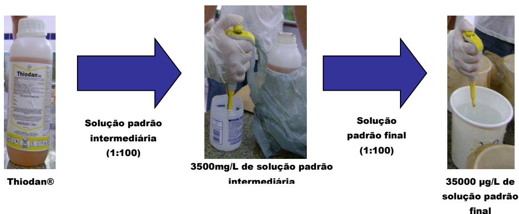
Figura 4. Preparação da solução padrão final do Thiodan ® .
