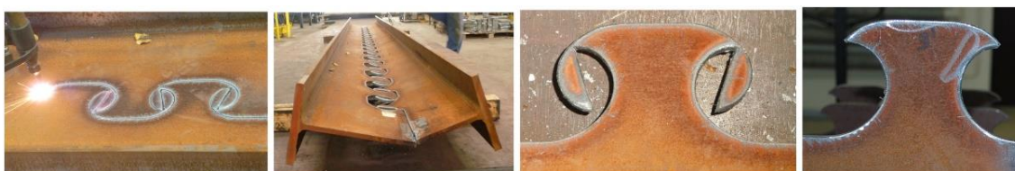
Fig. 2.11 – Estágios de fabricação de vigas de aço T invertido com conector MCL.
