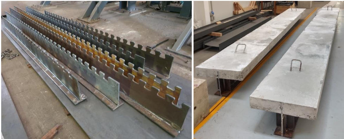
Fig. 1.3 - Vigas mistas tipo Crestbeam : perfis de aço T invertido após operações de corte e solda (a) e vigas após concretagem da laje (b).
