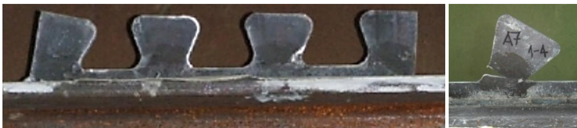
Fig. 2.22 – Falha do aço do conector Crestbond.
