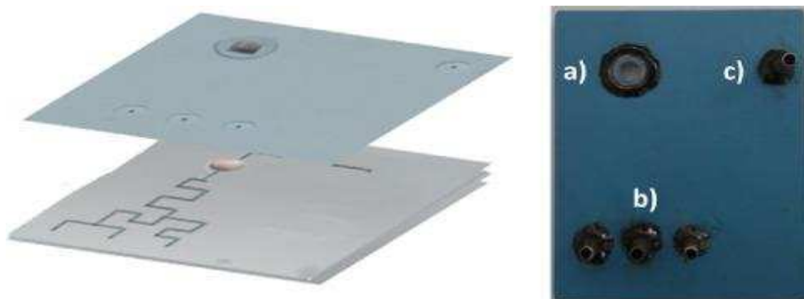
Figura 3: Layout do dispositivo construído com LTCC, (a) janela de entrada óptica, (b) entradas de reagentes, (c) saída de reagentes.
