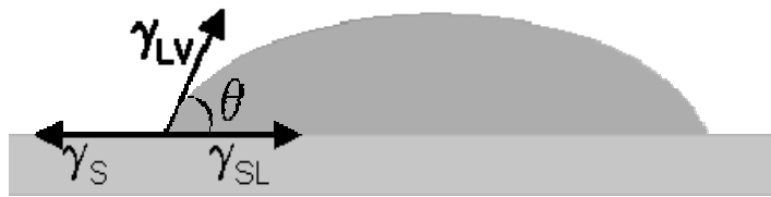
Figura 1 – Ângulo de contato ( \theta ) entre uma gota e uma superfície plana e horizontal. As tensões superficiais da superfície do sólido, do líquido em equilíbrio com o vapor e superfície e líquido, respectivamente, \gamma_S , \gamma_{LV} e \gamma_{SL} .
