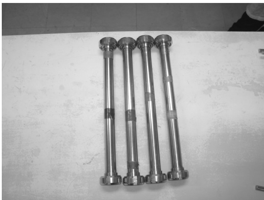
Figura 9 – Tubos de prova de aço inoxidável AISI 304 polimento n° 4, com 33 cm de comprimento, diâmetro de 3,1 cm e extremidades fechadas com tampas rosqueáveis.
