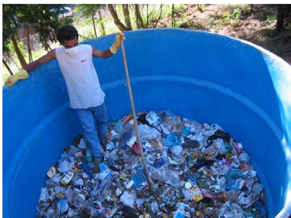
Figura 9 - Detalhe do preenchimento reservatório produtor de percolado.
