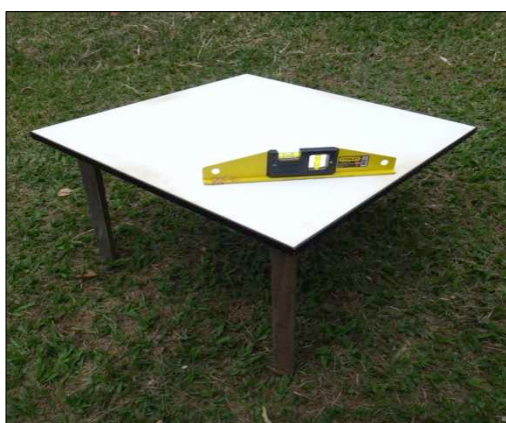
Figura 2A – Placa de referência utilizada na calibração das resoluções espaciais das imagens digitais.
