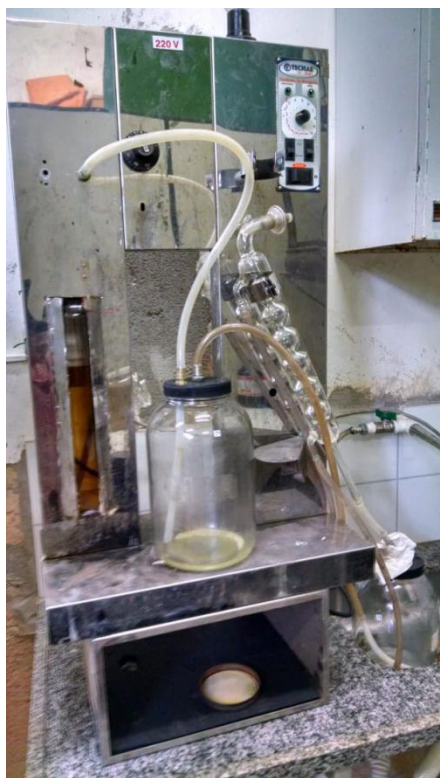
Figura 6 - Destilador de acetona desenvolvido a partir da junção de peças de outros equipamentos que estavam em desuso.
