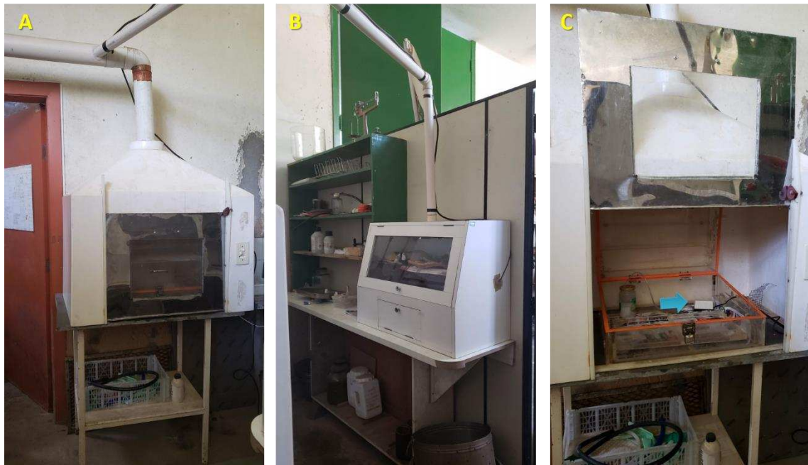
Figura 8 - Capelas de fluxo adaptadas como câmaras de cura. A e B- Capelas interligadas ao sistema de exaustão da sala de desidratação e impregnação. C- Câmara secundária de cura no interior da capela de fluxo, com a presença de bomba de borbulhamento do agente endurecedor.
