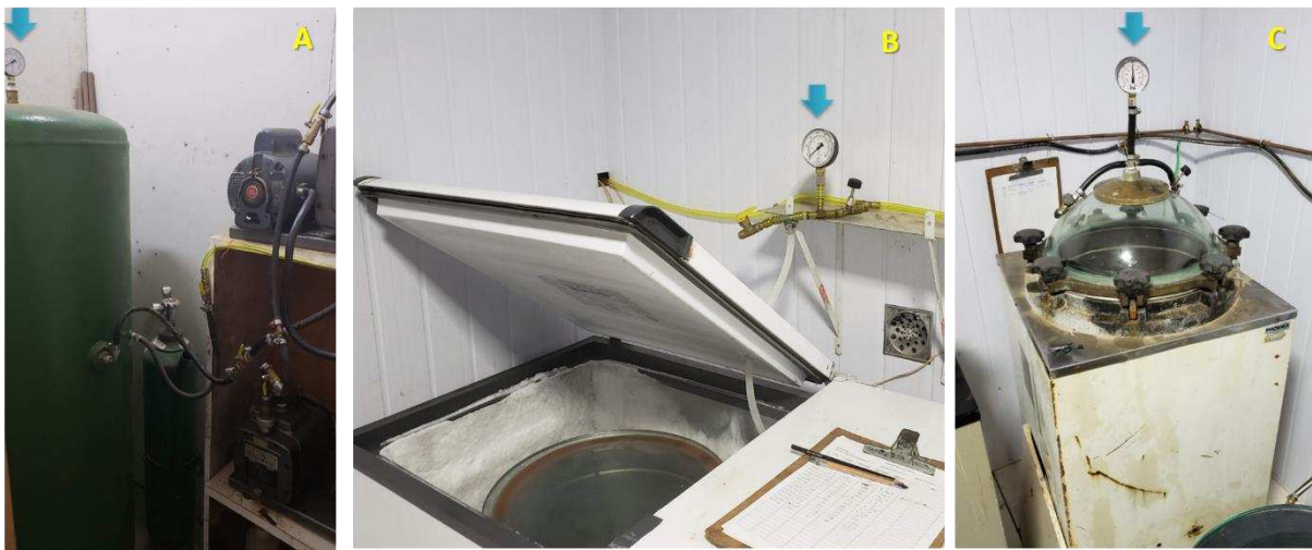
Figura 7 - Central de produção e armazenamento de vácuo, linha de distribuição e câmara de impregnação. A- Reservatório cilíndrico interligado à bombas e linha de distribuição de vácuo. B- Câmara de impregnação no interior do freezer, interligada ao sistema de distribuição. C- Câmara de impregnação à temperatura ambiente, adaptada de equipamento reciclado de autoclave. Setas destacam a presença de vacuômetros em diferentes componentes do sistema.
