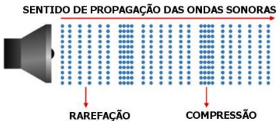
Figura 25: Sentido de propagação das ondas sonoras
