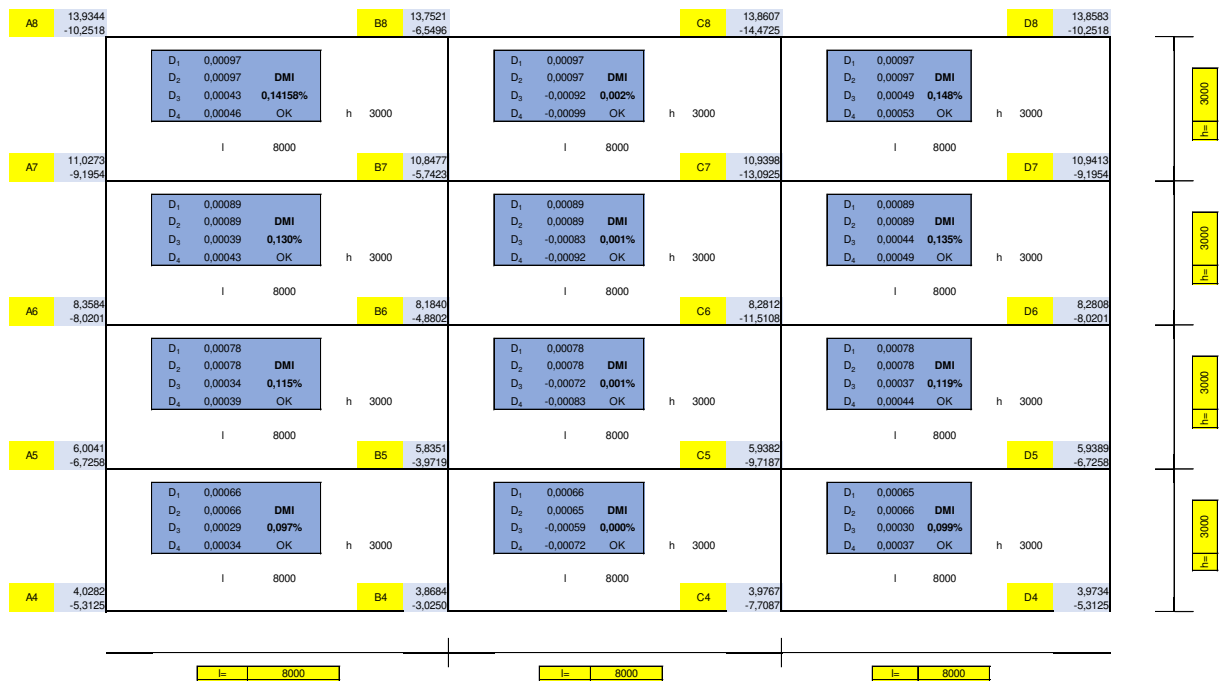
Figura B.1.2.2 – Avaliação das distorções do 5º ao 8º pavimento.
