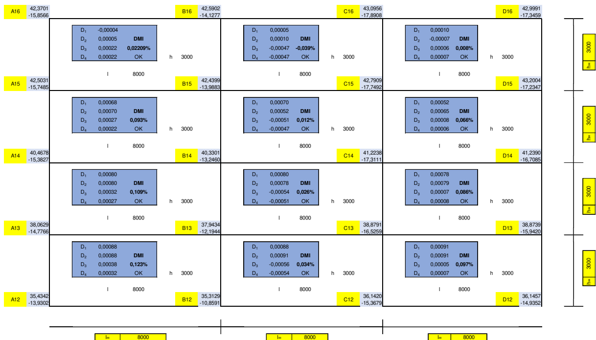
Figura B.2.4.4 – Avaliação das distorções do 13º ao 16º pavimento.
