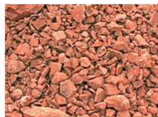
f) Macadame seco: detalhe
