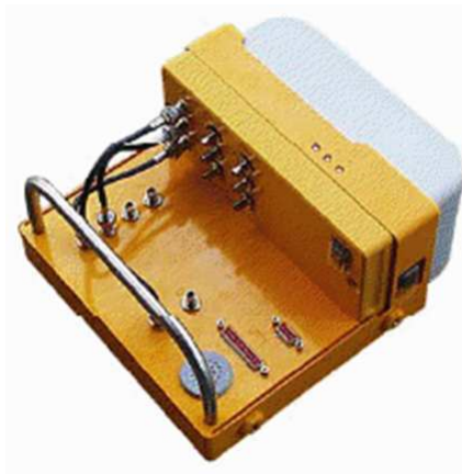
Figura 42. Sistema RAMAC desenvolvido pela MALA Geoscience .
