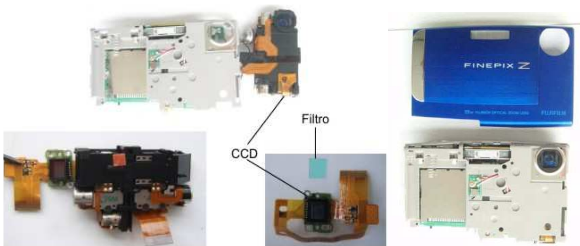
Figura 12 – Câmera aberta mostrando a retirada do filtro colorido.
