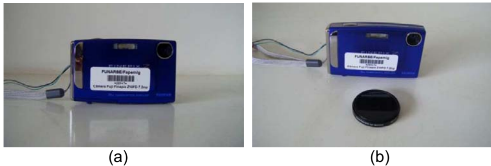
Figura 11 – Câmera utilizada para captar imagens coloridas (a); e câmera adaptada para captar imagem infravermelha com filtro marca B+W (b).
