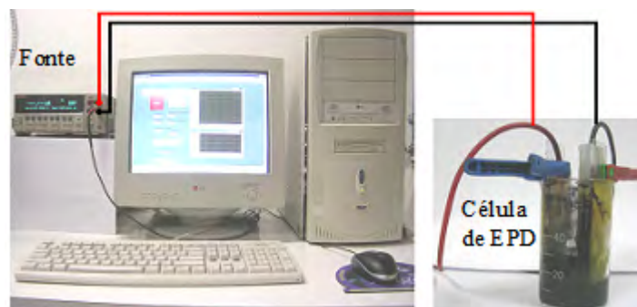
Figura 3.10: Montagem para a Deposição Eletroforética.
