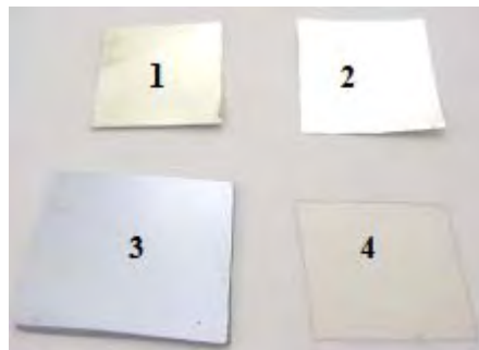
Figura 3.2: Amostras típicas dos substratos utilizados para deposição eletroforética de CNT's. Condutores: aço inox (1), alumínio (2); semicondutor: silício (3) e condutor iônico: Nafion ® (4).
