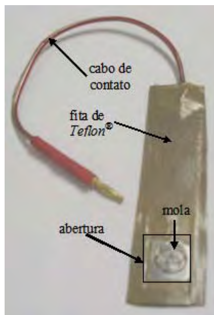
Figura 3.3: Exemplo do primeiro suporte para eletrodo de trabalho desenvolvido.
