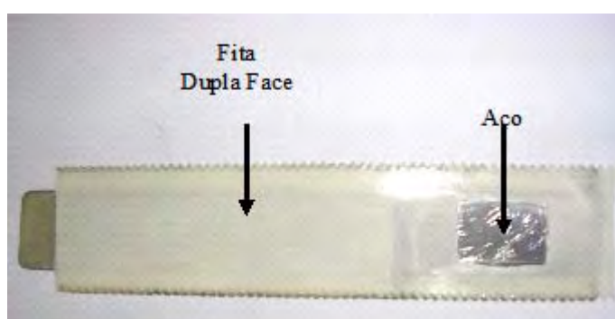
Figura 3.6: Exemplar do suporte revestido com fita adesiva de Teflon ® .
