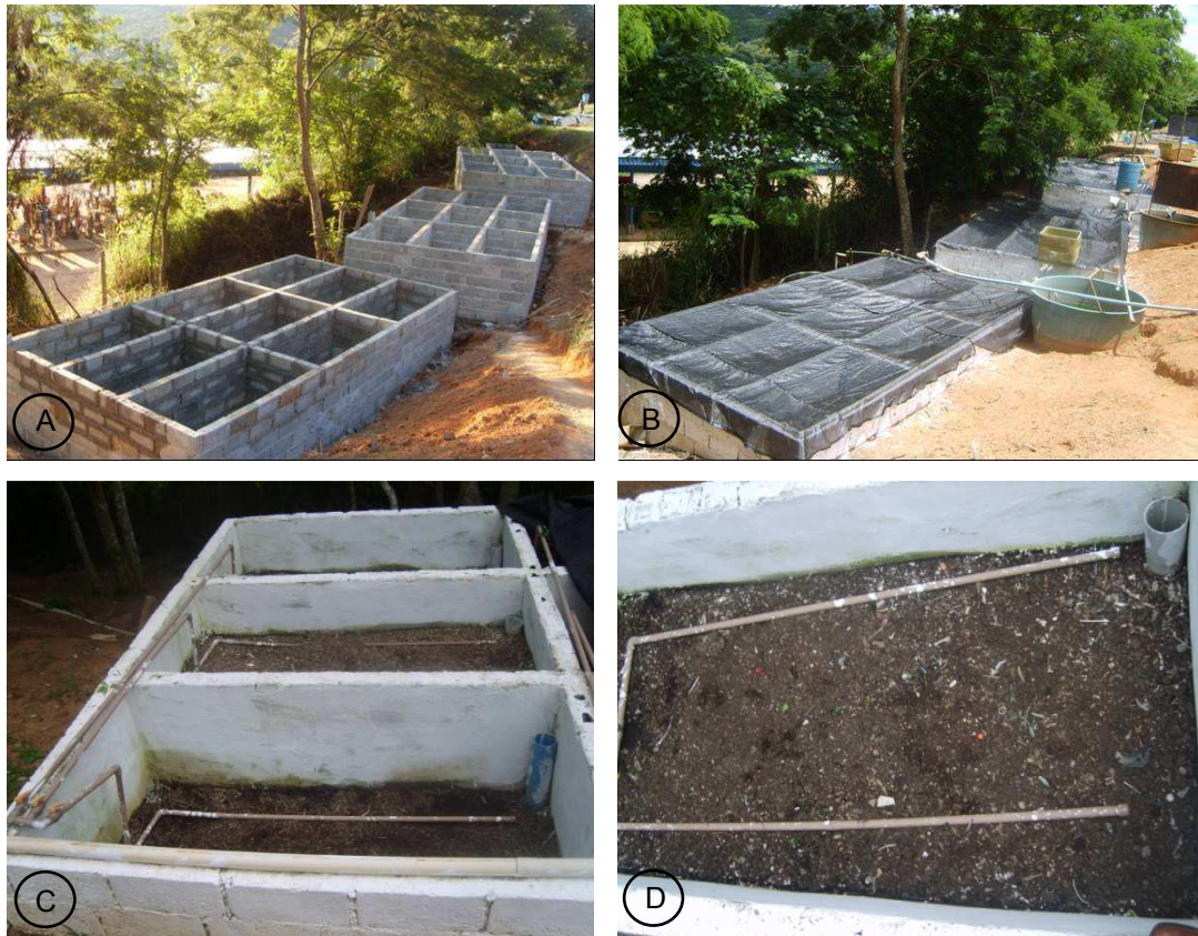
Figura 2 – Protótipos: construídos em alvenaria, nas dimensões de 1,0 m de largura por 2,0 m de comprimento por 1,2 m de altura, destacando-se a vista frontal (a); protegidos com sombrite (b); preenchidos com materiais orgânicos (lixo compostado, bagaço de cana-de-açúcar e serragem de madeira) (c); e contendo lixo orgânico compostado com a tubulação de alimentação do sistema (d).
