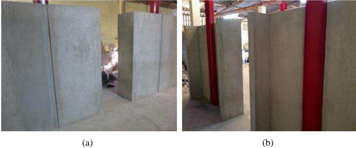
Figura 58 – Exemplos do modelo experimental após finalização do tratamento com selante: a) faces externas; b) faces internas.
