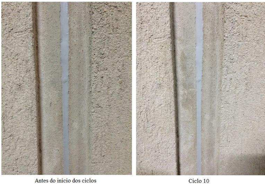
Figura 93 – Detalhe do selante após aquecimento do modelo experimental PAR-JV-R2 na região C indicada.
