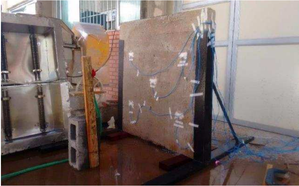
Figura 33 – Sistema de resfriamento dos painéis de concreto.
