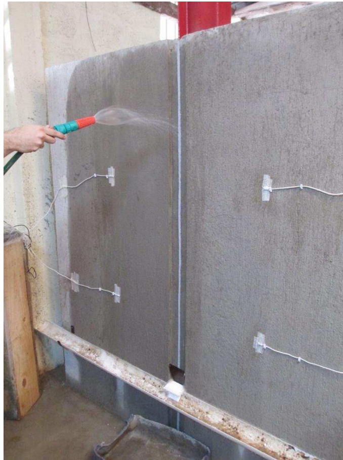
Figura 66 – Procedimento de resfriamento do modelo experimental com auxílio de uma mangueira com bico aspersor de água.
