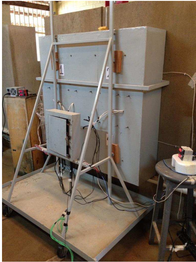
Figura 67 – Ensaio de exposição à ação do calor e choque térmico em andamento.
