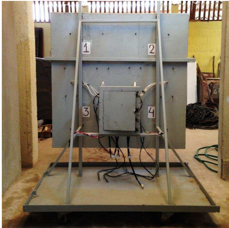
Figura 43 – Vista posterior do painel com identificação dos grupos de aquecimento.
