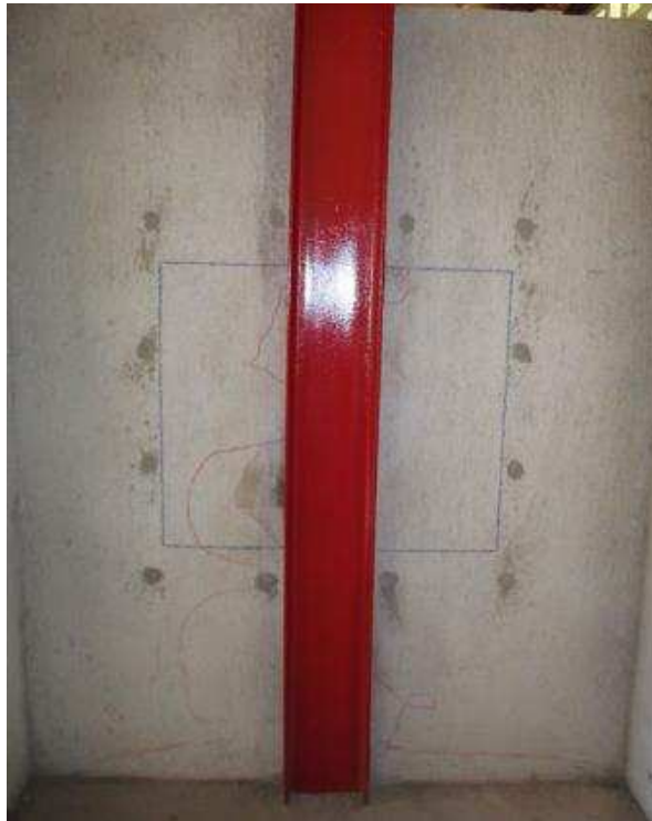
Figura 100 – Face interna do modelo experimental PAR-JV-R1 após o término do ciclo 8.
