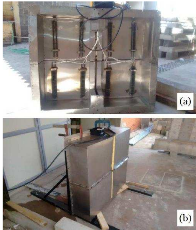
Figura 31 – Aspectos gerais do forno modular desenvolvido no FECIV-UFU: a) vista do interior do forno com resistências tubulares aletadas; b) vista do exterior do forno na posição de ensaio.
