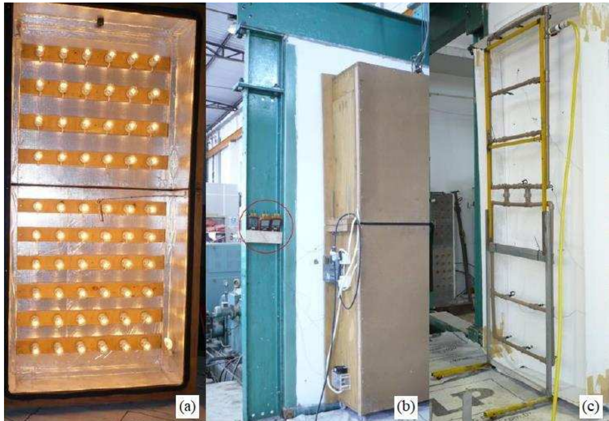
Figura 24 – Aspectos gerais do painel radiante utilizado no ensaio de exposição à ação do calor e choque térmico: a) disposição das lâmpadas incandescentes painel radiante; b) posicionamento do painel radiante para realização do ensaio; c) dispositivo de resfriamento.
