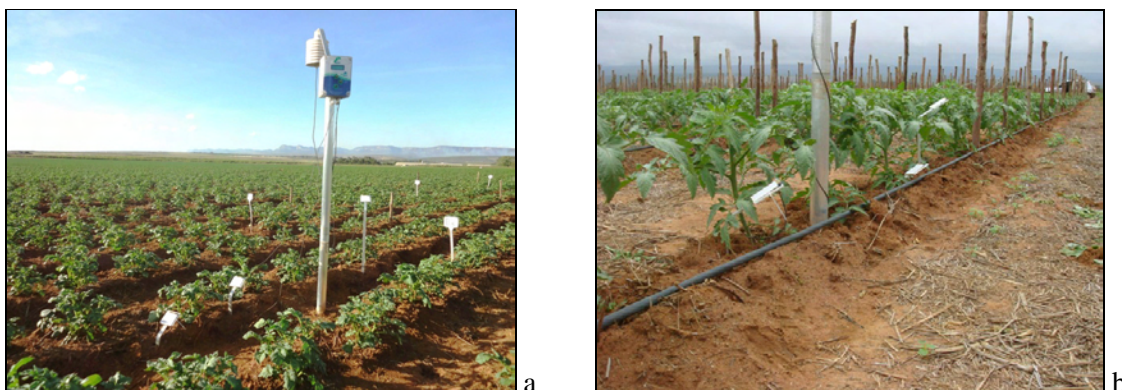
Figura 5 – Disposição dos sensores no dossel da cultura da batata a e na cultura do tomate b
