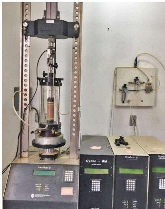
Figura 6: Prensa de ensaio triaxial cíclico utilizada para ensaios de MR
