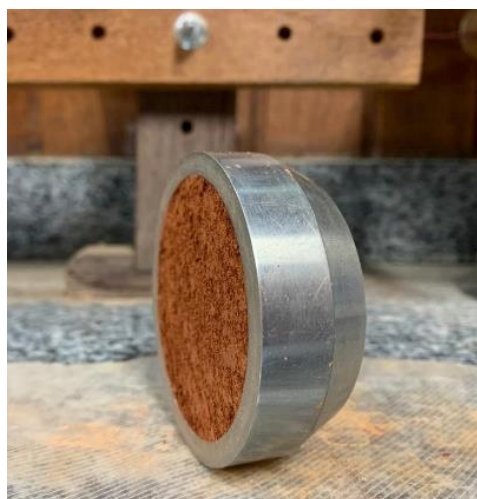
Figura 8: Secagem do corpo de prova para o ensaio CRS
